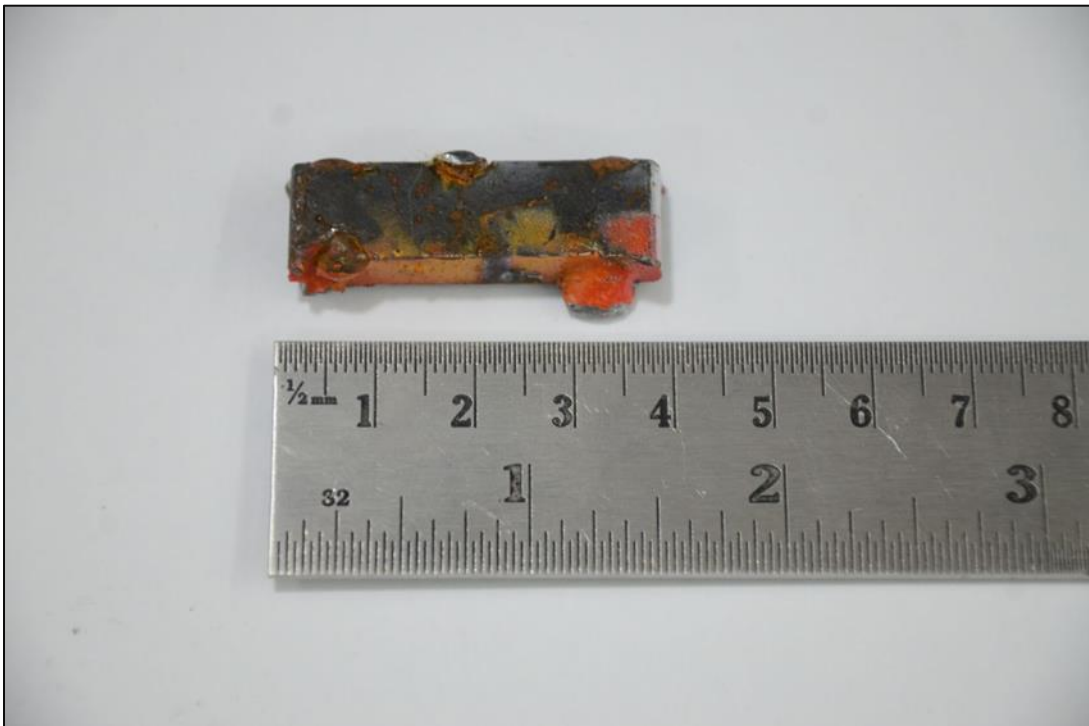
Fotografías No. 23 y 24: Piezas de sujeción de secciones de candileja. Son piezas comerciales fabricadas en acero AISI 1020. Tabla TAL. Ref. 4 y 5
