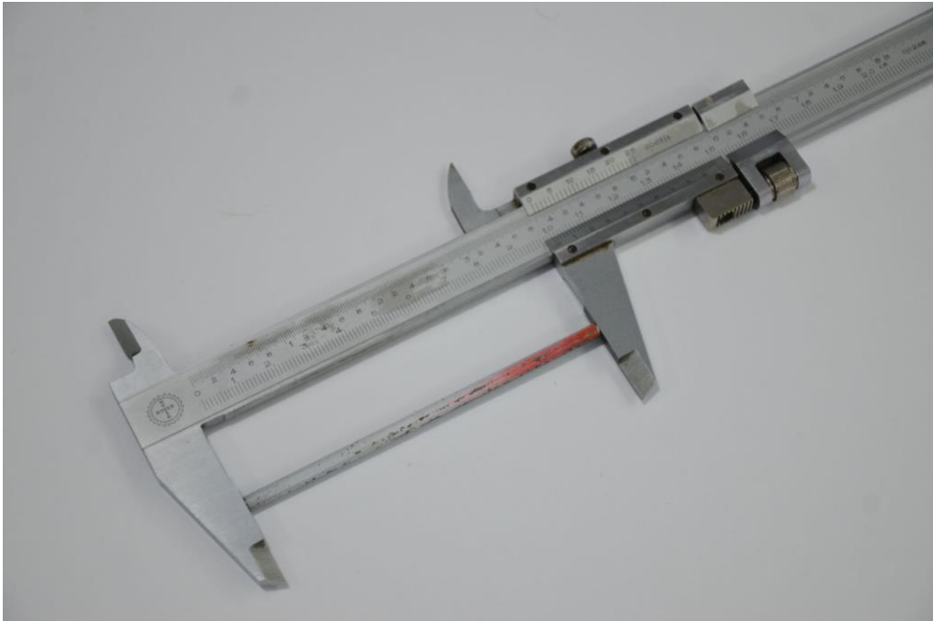
Fotografía No. 21: Sección de la malla de la candileja. Esta malla servía para sujeción del globo mientras era llenado de aire en tierra. Está fabricada con varilla mecánica con diámetro de 5/32" de acero 1020. La mayor parte del FOD encontrado en los motores del avión corresponde a esta sección.
