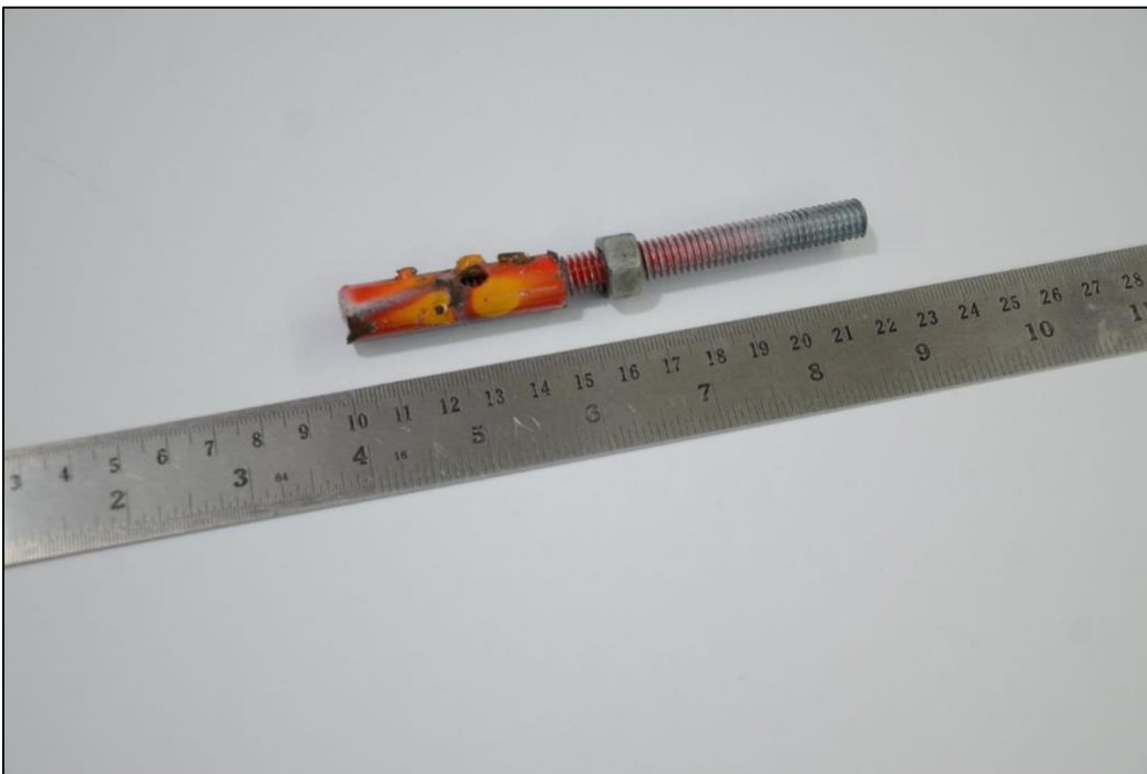
Fotografías No. 17 y 18: Espárrago 3/8"-16, Longitud 120 mm – Usado para las uniones entre secciones de la candileja. Tabla TAL. Refs. 5, 7 y 8.
