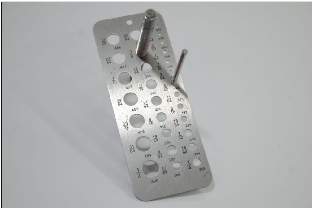
Fotografía No. 22: Medición de los pernos y de la sección de la malla metálica usada en la candileja. Son piezas comerciales fabricadas en acero AISI 1020, y con diámetros de 3/8" y 5/32" respectivamente.
