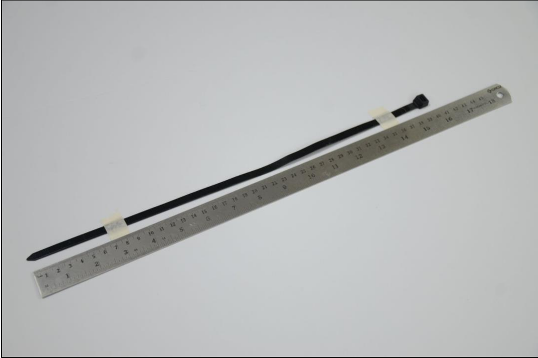
Fotografía No. 19: Amarras plásticas de polietileno de alta densidad. Longitud 400 mm – Ancho: 8mm Estas amarras tienen la función de unir el globo a la candileja. Tabla TAL. Ref. 11
