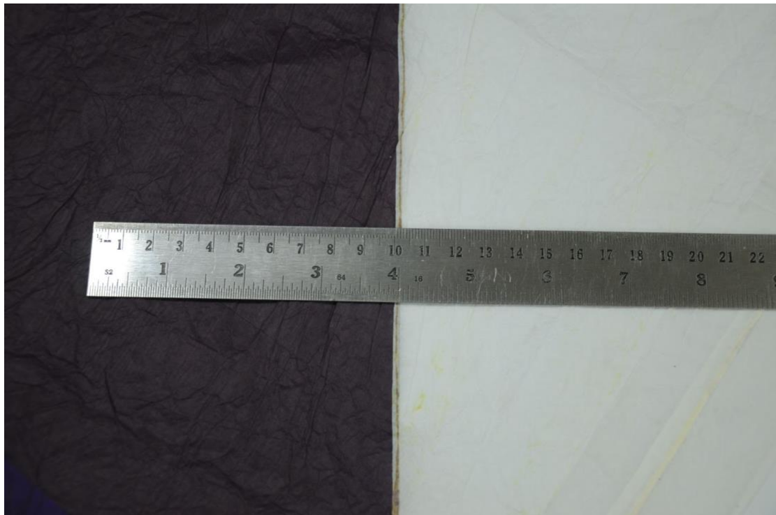
Fotografías No. 13 y 14: Detalle de las uniones entre cada pliego (total: 8000). Entre pliego y pliego existe una superposición de al menos 5 mm de material; en estas uniones se deposita pegamento como material de adhesión.
