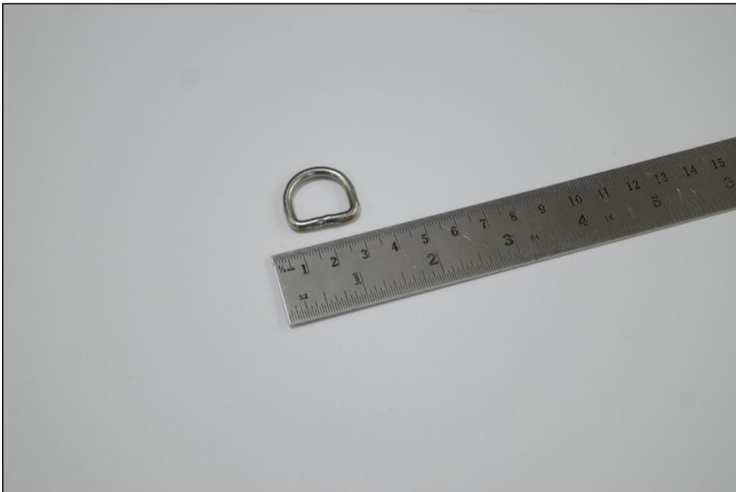
Fotografía No. 20: Gancho metálico para unión de candileja con amarras plásticas e hilo de Kevlar.
