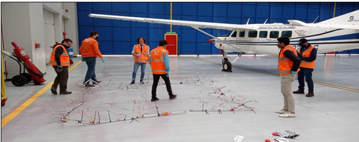
Fotografías No. 11 y 12: Expertos de CIPSELA y del GRIAA efectuando el levantamiento dimensional de la candileja del globo aerostático.
