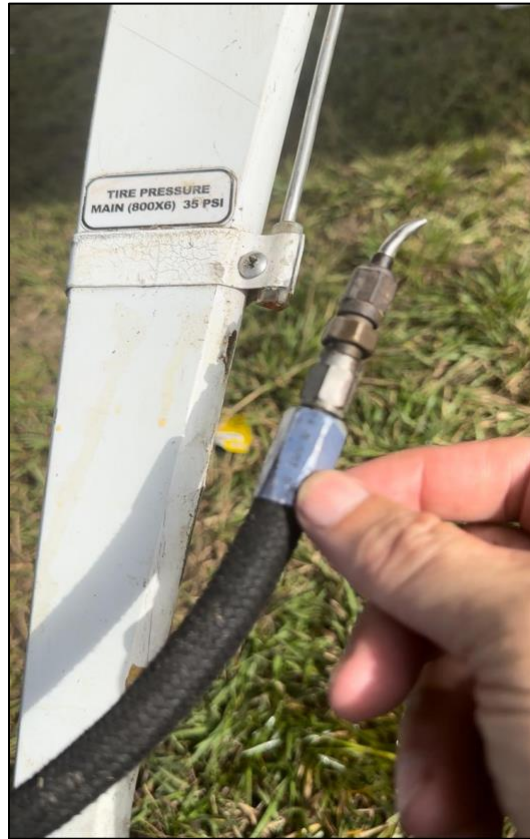
Fotografía No. 3: Rotura de la línea de hidráulico del freno.
