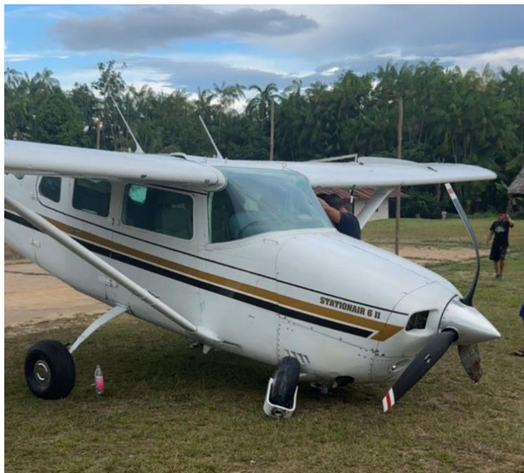
Fotografía No. 4: Daños presentados en la Hélice y tren del morro.
