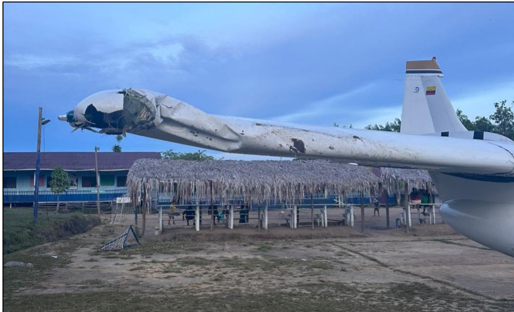
Fotografía No. 6: Daños presentados en el plano derecho.
