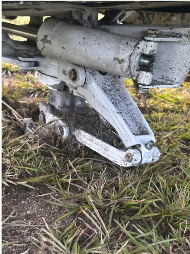
Fotografía No. 5: Desprendimiento de la rueda del tren del morro.
