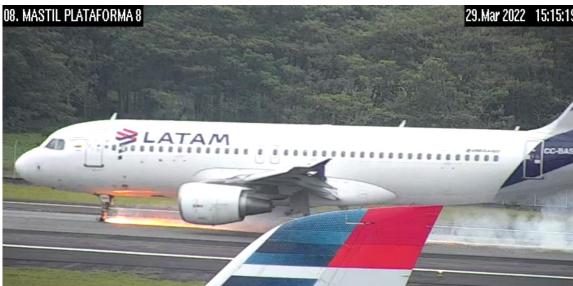
Fotografía No. 7 – Fotograma de deslizamiento y abrasión de la estructura - CC-BAS
