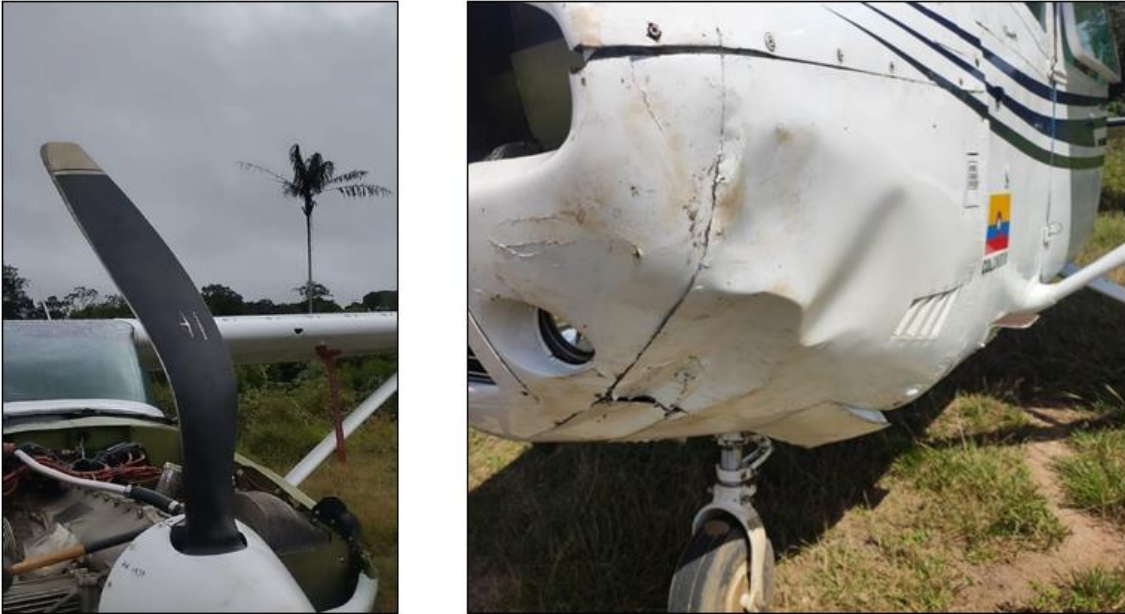
Fotografía No. 4: Izquierda- doblamiento de una de las palas. Derecha- abolladuras en la parte inferior de la cubierta del motor de la aeronave HK 1937.
