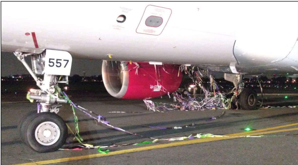
Fotografía No. 2: FOD (restos del globo) en motor RH y MLG RH N557AV
