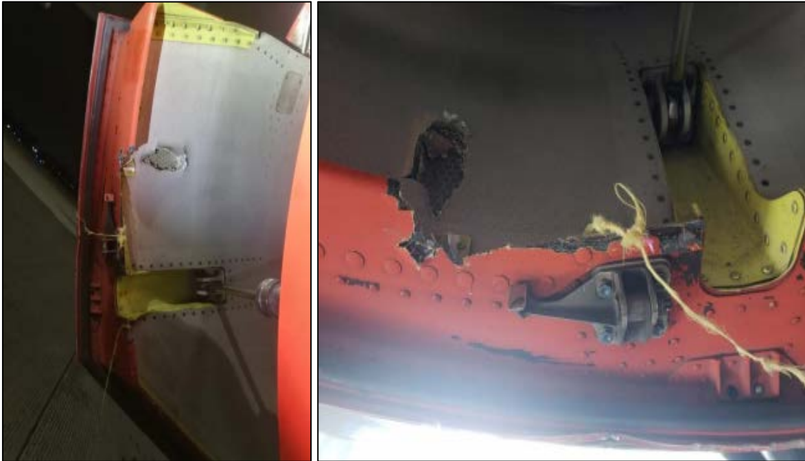
Fotografía No. 5: Daños en las “Lower pivoting doors” derechas del reversible motor RH
