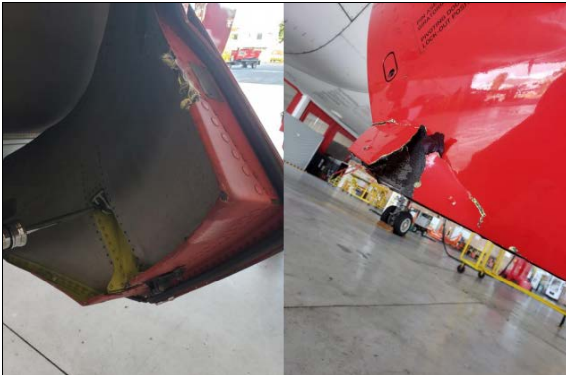
Fotografía No. 6: Daños en las “Lower Pivoting doors” Izquierdas del reversible motor RH
