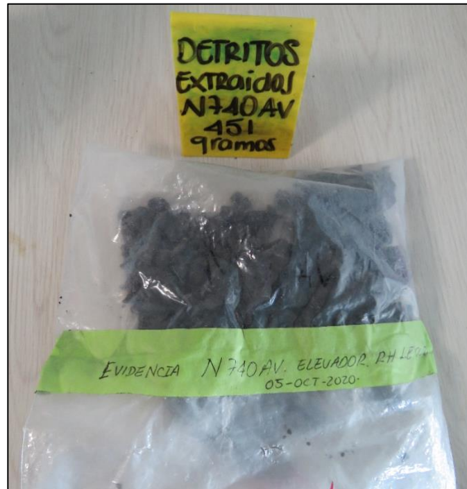
Fotografía No. 9: Detritos encontrados al interior del estabilizador horizontal RH N740AV
