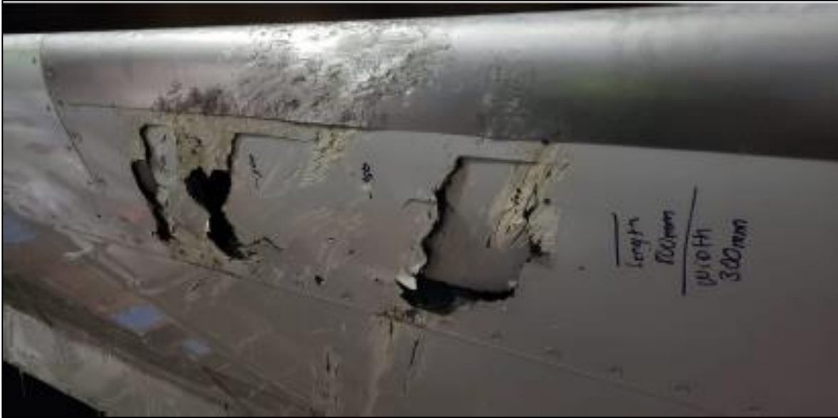
Fotografía No. 2: Acercamiento daños estabilizador horizontal RH aeronave N740AV
