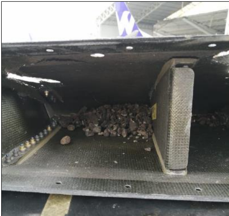
Fotografía No. 3: Daños internos y detritos alojados en estabilizador horizontal RH aeronave N740AV
