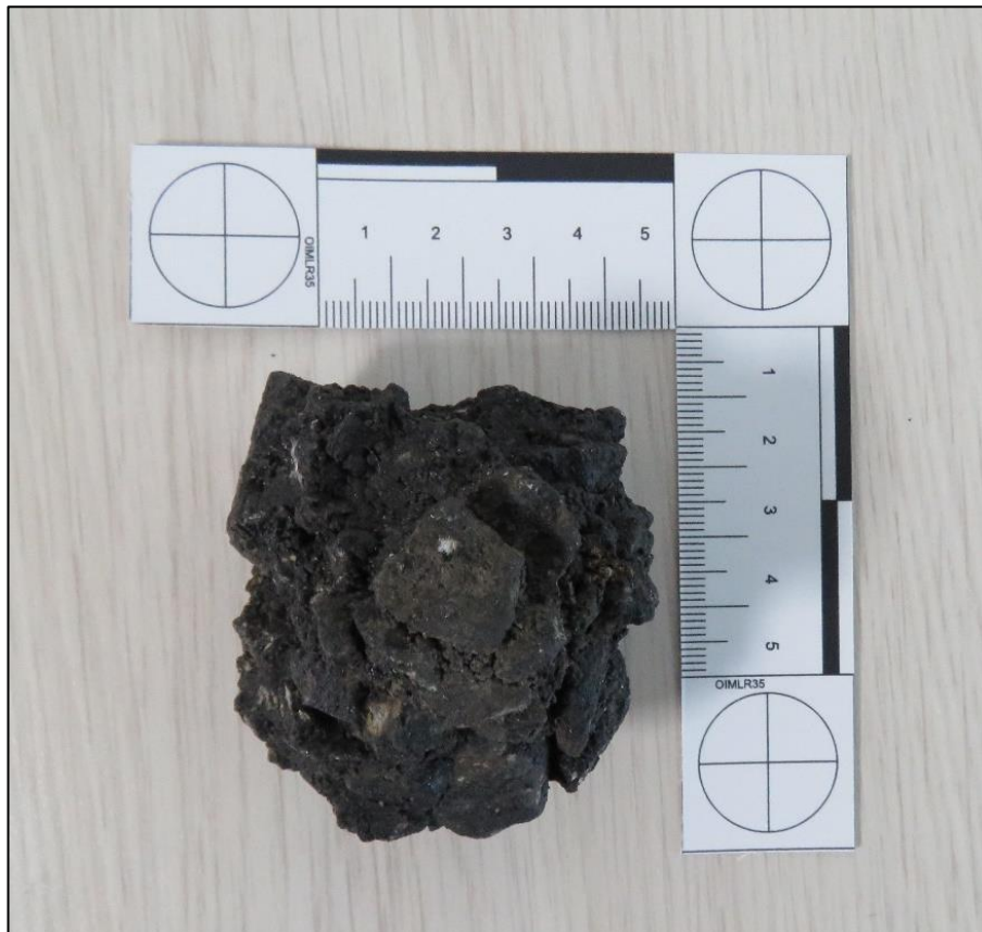
Fotografía No. 8: Detrito encontrado al interior del estabilizador horizontal RH N740AV
