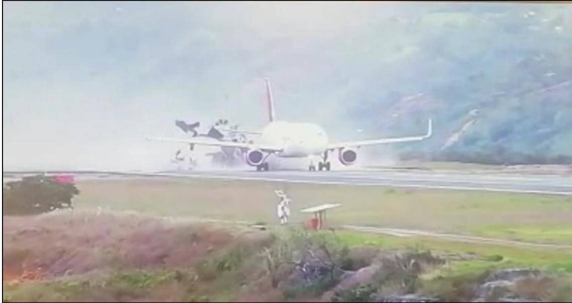
Imagen No. 1: Foto de video del desprendimiento de capa asfáltica e impacto de FOD al N740AV
