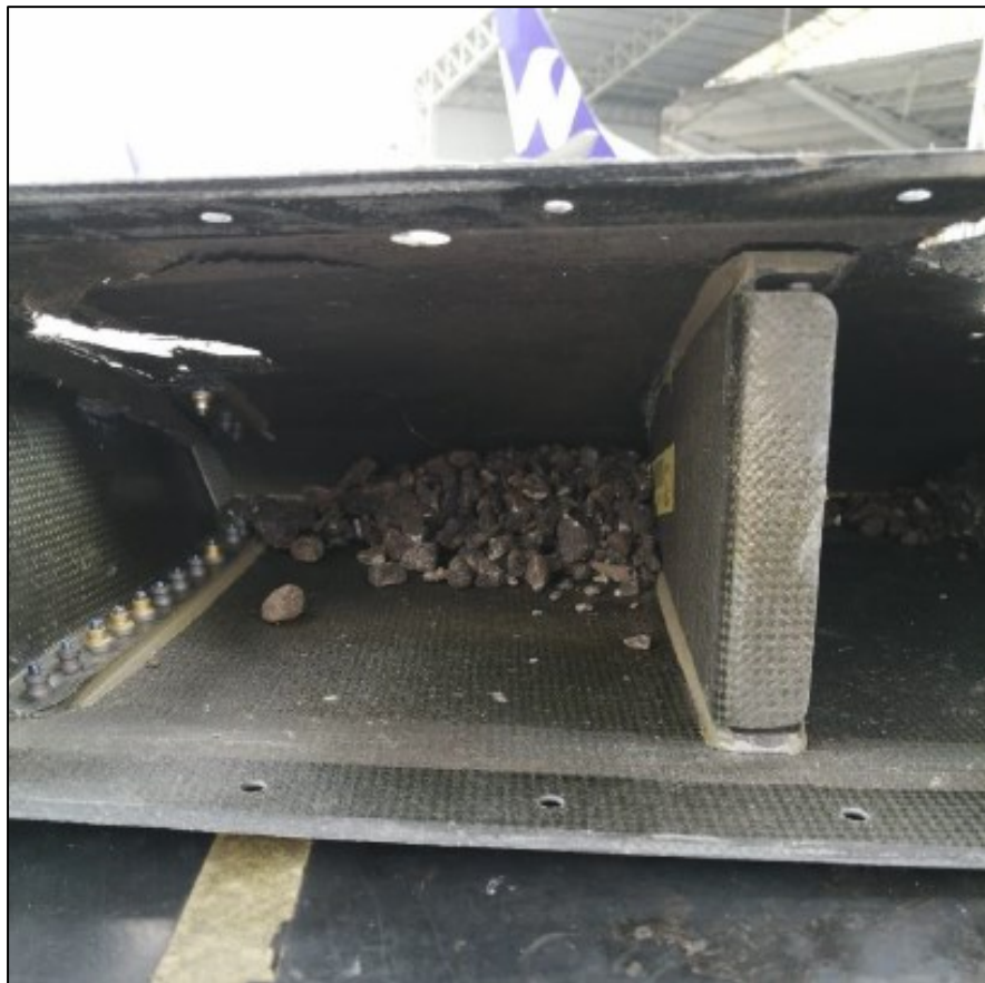
Fotografía No. 2: Daños internos estabilizador horizontal RH aeronave N740AV
