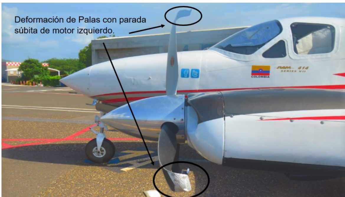
Fotografía No. 4 - Daños en las palas de la hélice motor izquierdo.
