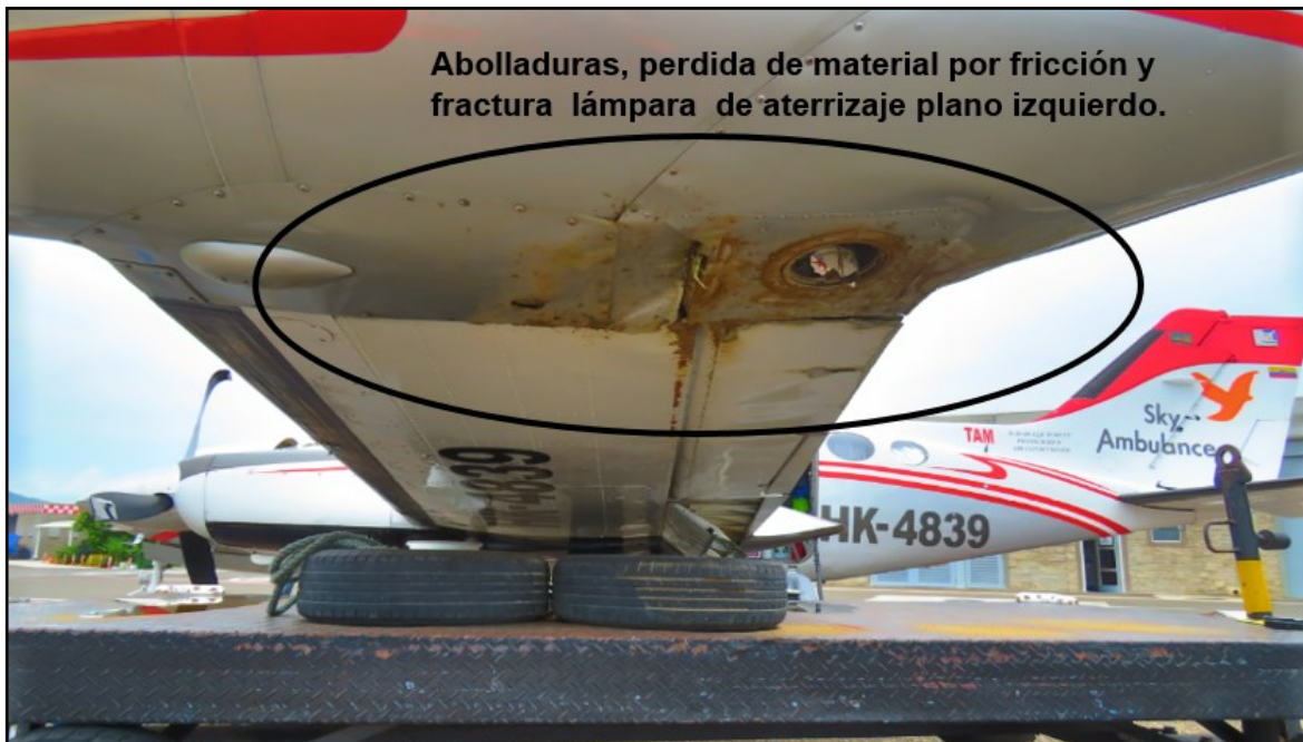
Fotografía No. 3 - Daños en la punta del plano izquierdo.
