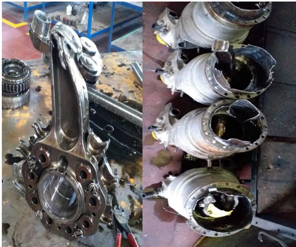
Fotografías No. 3 y 4 se observa la biela maestra rota y los cilindros golpeados en su totalidad
