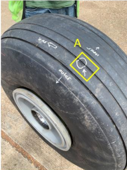
Fotografía No. 2 – Evidencias del tornillo incrustado en el neumático del tren izquierdo HK2006
