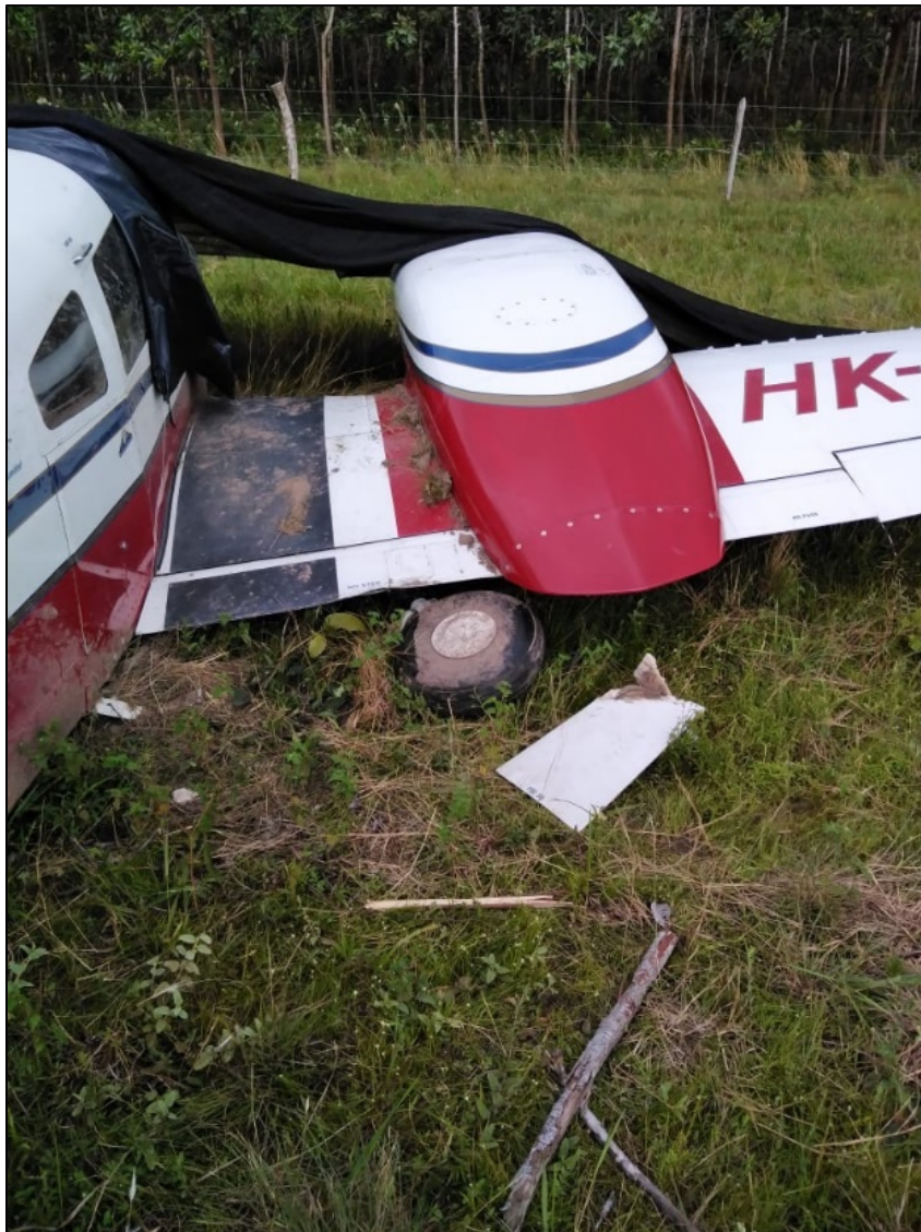
Fotografía No. 4: desprendimiento tren de aterrizaje principal izquierdo.
