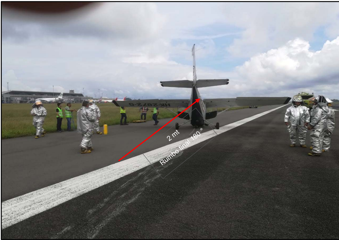
Fotografía No. 6: Registro de las marcas en pista dejadas por la hélice y tren de nariz del HK2872-G
