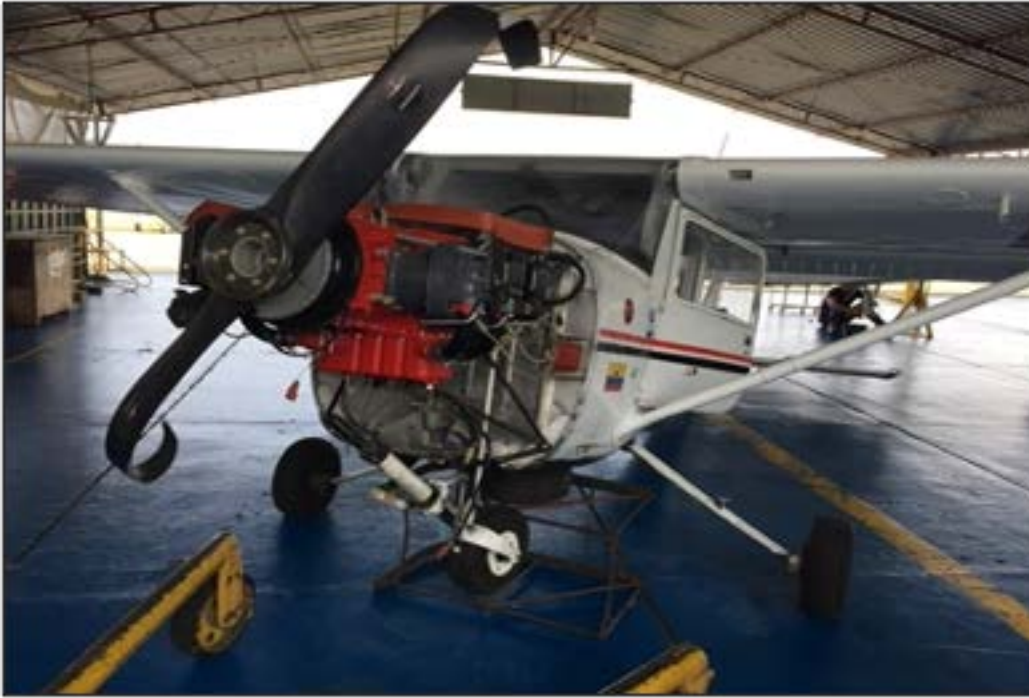
Fotografía No. 4: Daños en hélice y motor del HK2872-G
