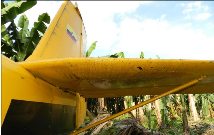
Imagen No. 2 – Apariencia general del estabilizador horizontal derecho HK5253
