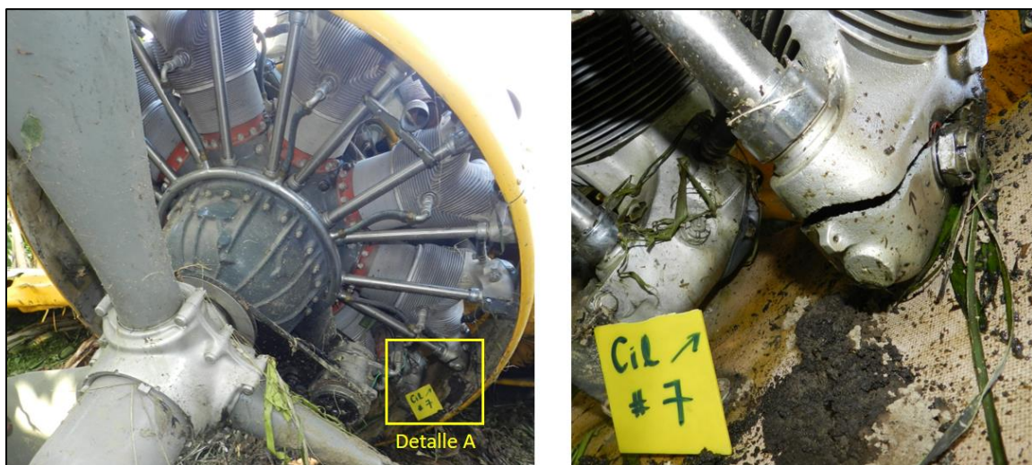
Imagen No. 1 – Condición final del motor Pratt & Whitney R-1340-S3H1
