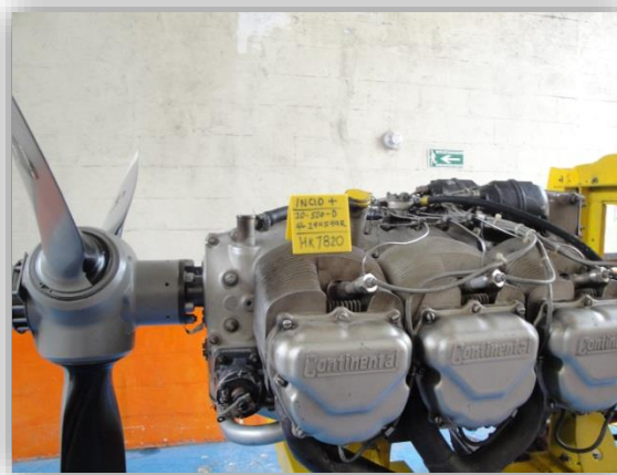
Motor del HK1820 en banco de pruebas
