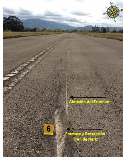
Fractura y Retracción Tren de Nariz
