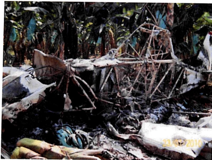
La aeronave a causa del impacto quedó compacta, sin embargo, el fuego produjo su destrucción total
