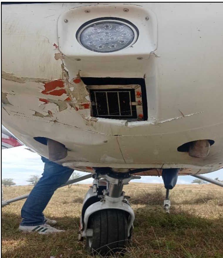
Fotografía No. 2 - Golpe en la parte delantera derecha del capó del motor.
