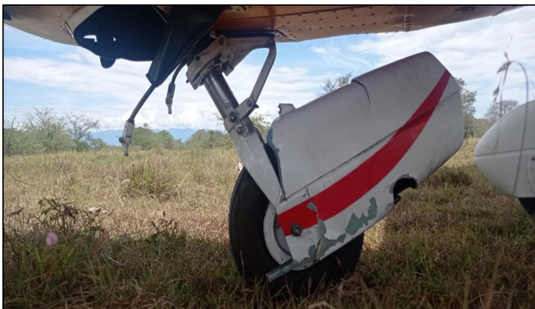
Fotografía No. 1 - Fractura y desprendimiento del tren de nariz de la estructura principal.
