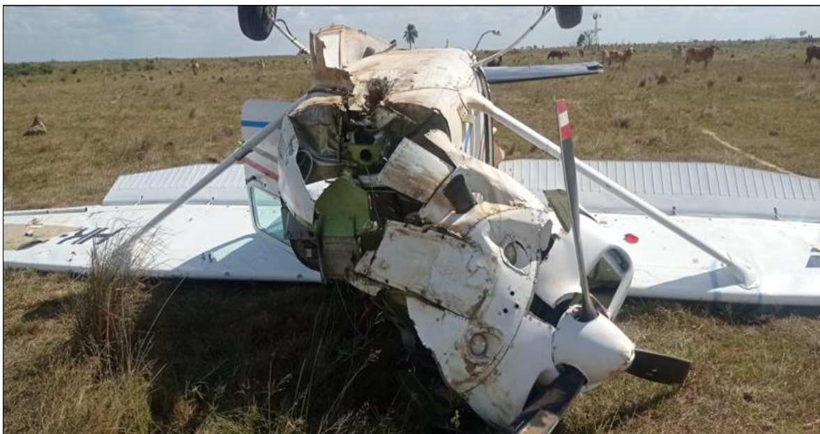
Fotografía No. 2 - Desprendimiento del motor desde la bancada.
