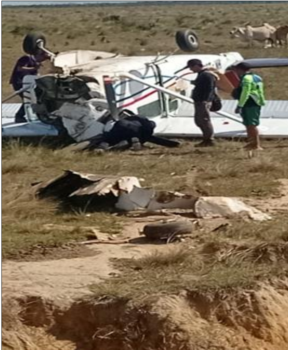
Fotografía No. 4 - Desprendimiento del tren de nariz.
