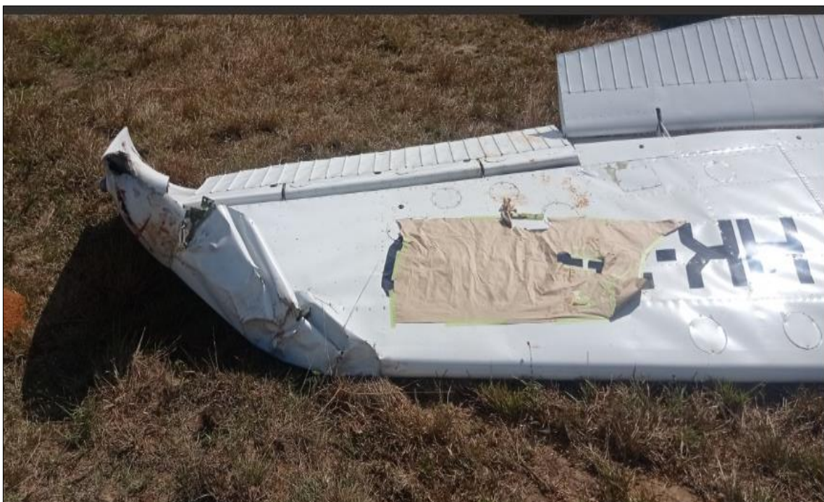
Fotografía No. 3 - Daños en el plano izquierdo.
