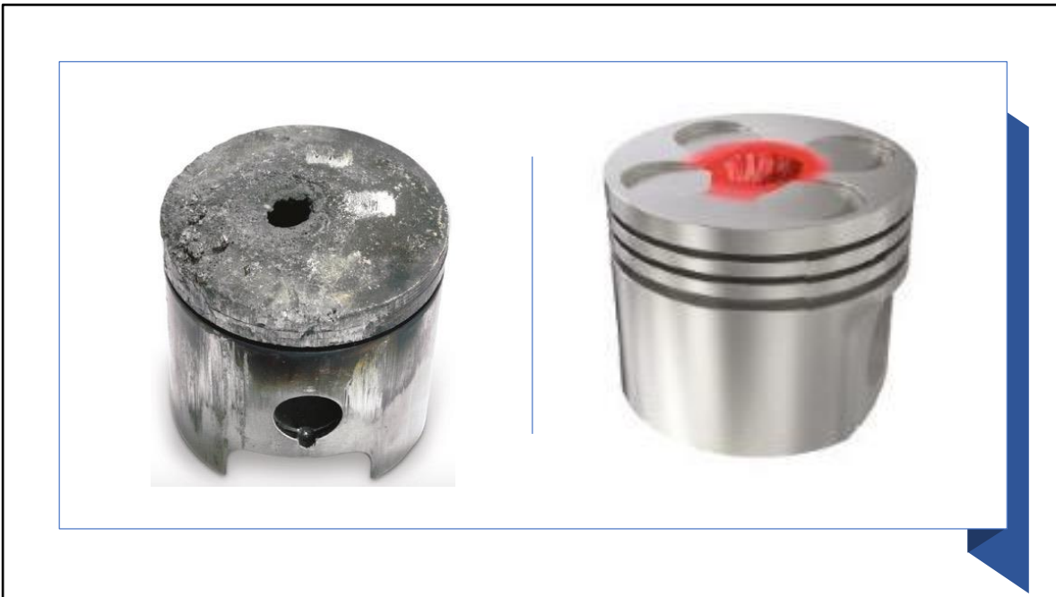
Imagen No. 5: Orificio en cabeza de pistón.
