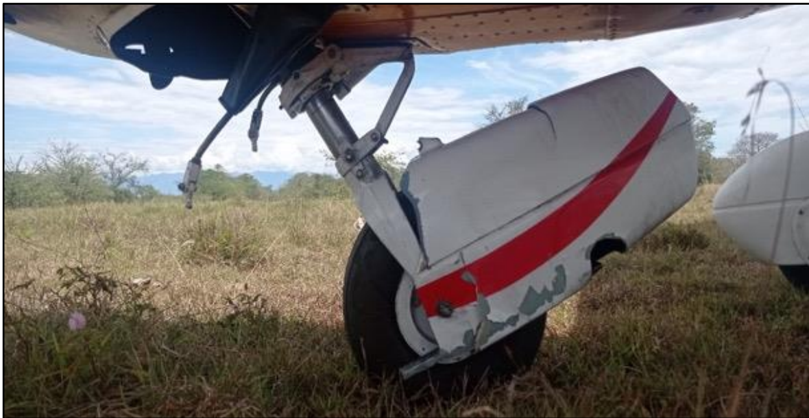
Fotografía No. 1: Fractura y desprendimiento del tren de nariz de la estructura principal.
