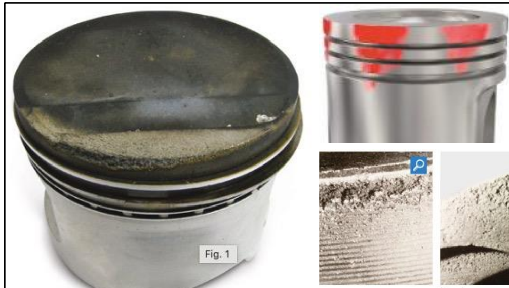
Imagen No. 7: Erosión en la pared de fuego y cabeza del pistón.
