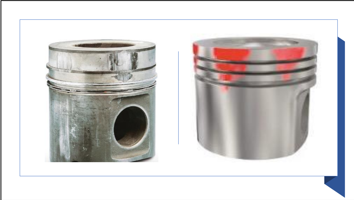
Imagen No. 6: Daños por pistón defectuoso.
