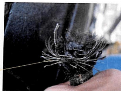
Hilos deshilachados manguera sistema de frenos
