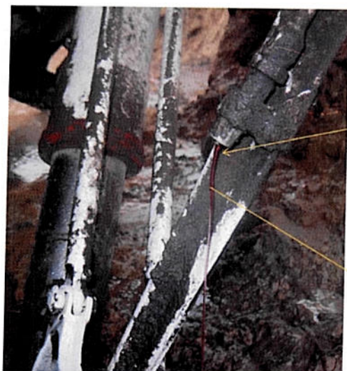
Escapa Fluido Hidráulico
