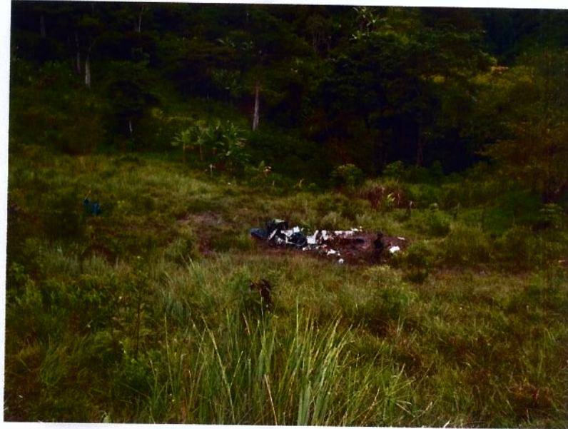
Evidencias de impacto con alto régimen de descenso, mínima velocidad horizontal y escasa o nula amortiguación del impacto
