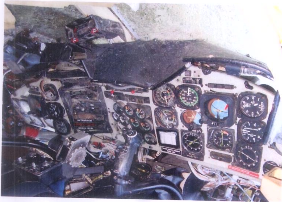
Foto 1.4 Aspectos de la cabina de pilotos, se observa la fractura de los vidrios frontales y deformación del pedestal central
