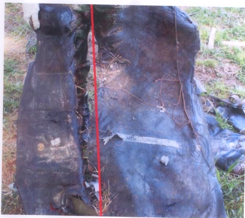
Foto 1.9.c. Ruptura del tanque de combustible del helicóptero militar H-500HS. La línea roja refleja el corte realizado por la pala del rotor principal del helicóptero B-222 U HK-3262.
