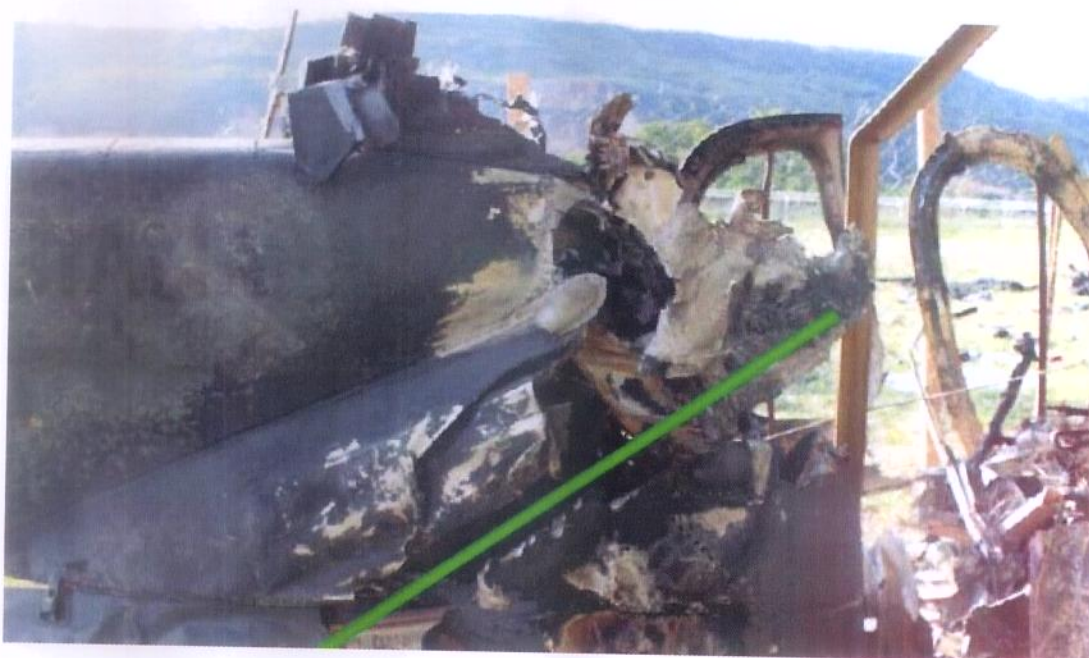
Foto 1.9.b. Reconstrucción del helicóptero militar H-500 HS. La línea verde refleja el corte realizado por la pala del rotor principal del helicóptero B-222U HK-3262.
