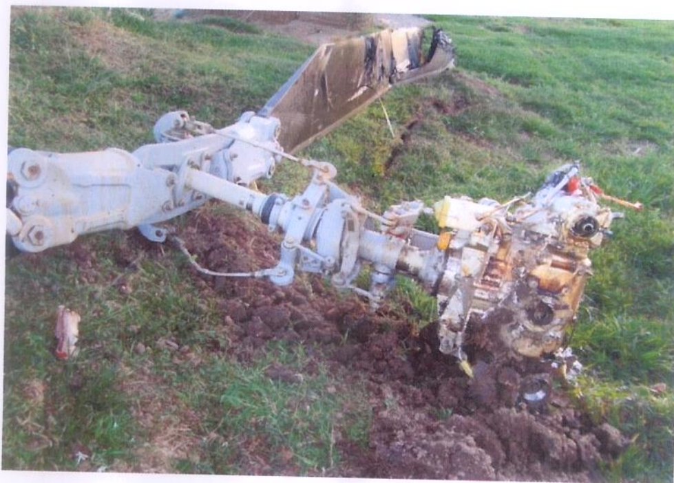
Foto 1.3 Transmisión principal y conjunto del rotor principal desprendidos de la estructura del helicóptero HK-3262
