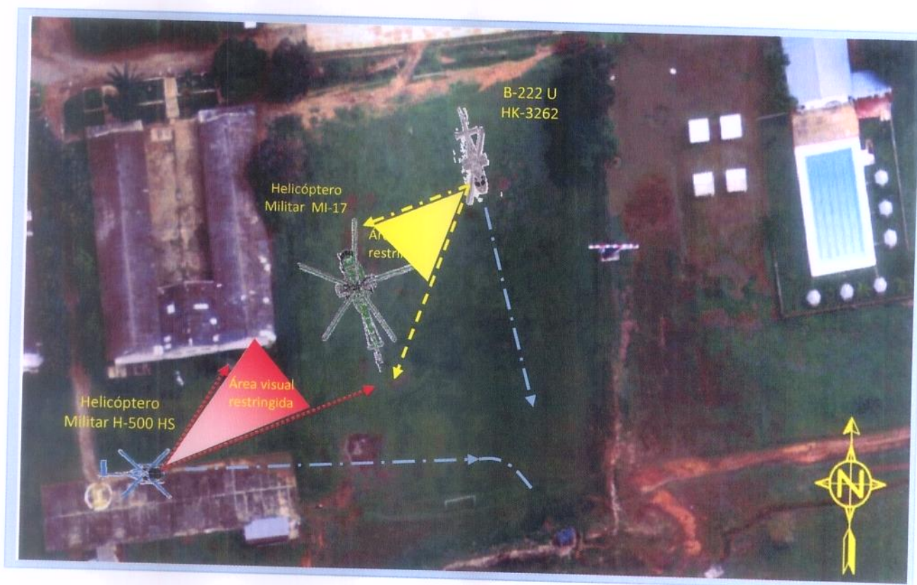
Foto 2.1. Fotomontaje para demostrar que las instalaciones y el helicóptero MI-17 parqueado en el la cancha de fútbol no permitieron contacto visual entre los pilotos de las aeronaves accidentadas mientras decolaban. La línea amarilla punteada el alcance visual restringido del B-222 y la línea roja punteada el alcance visual restringido del H-500 HS. Las líneas azules es la trayectoria de despegue de ambas aeronaves convergiendo.
