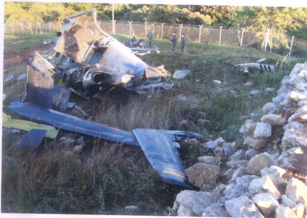
Foto 1.1 Apariencia general del helicóptero HK-3262. Posición invertida y fractura del tail boom. Al costado derecho superior se observa el rotor de cola
