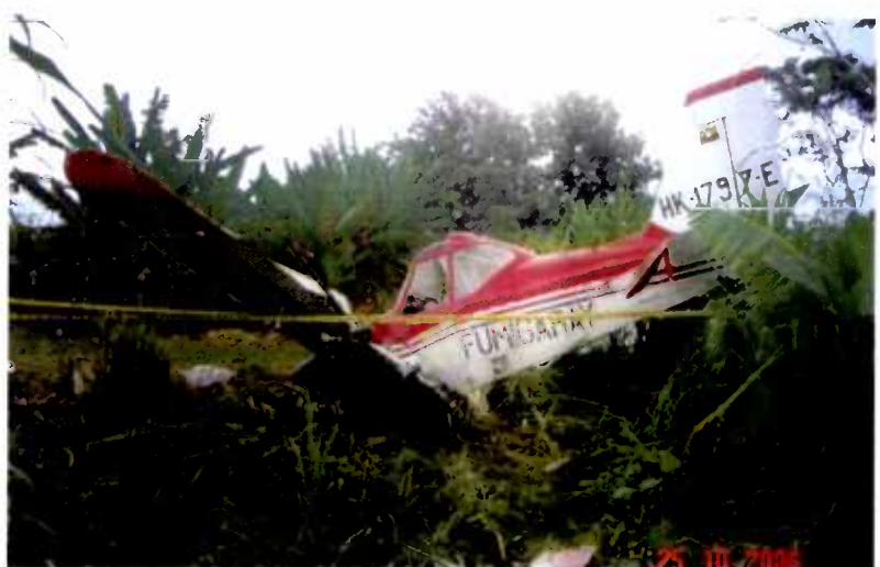
Vista lateral, daños mayores en los planos, parte frontal e inferior
