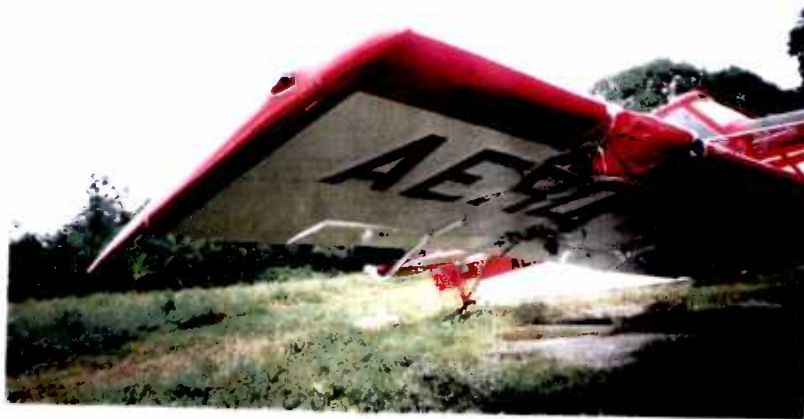
Abolladura en el borde de ataque del plano derecho causada por el impacto con los dos jornaleros
