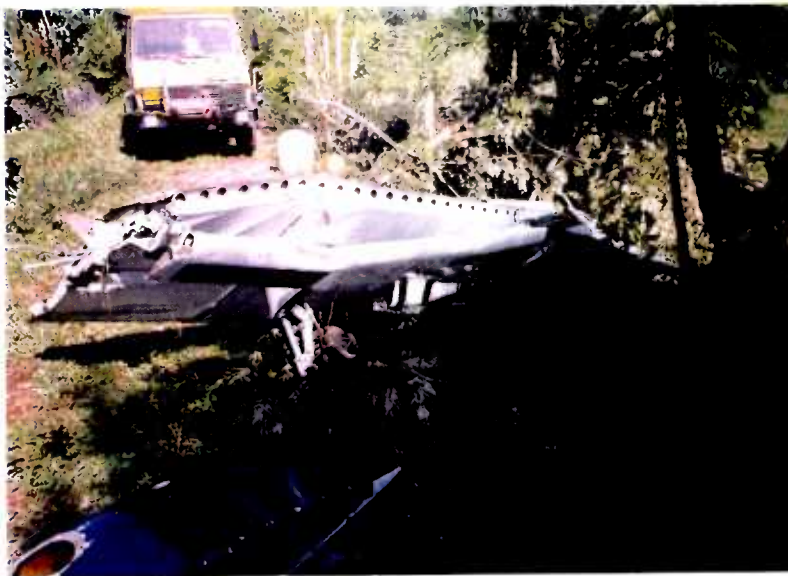
Daños estructurales en el plano derecho producto del impacto contra los árboles durante la entrada al campo de emergencia
