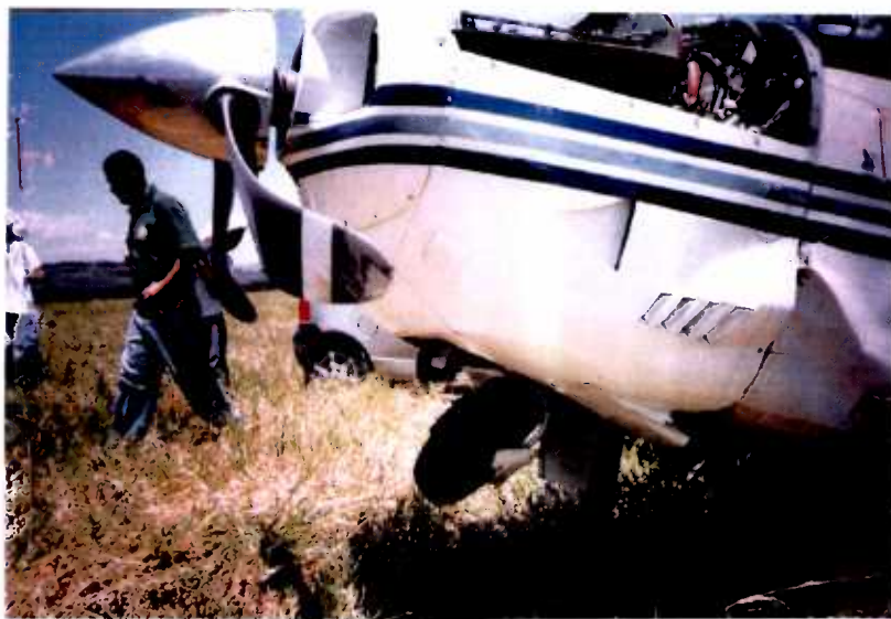
Detalle daños tren de nariz, hélice y fuselaje frontal inferior
