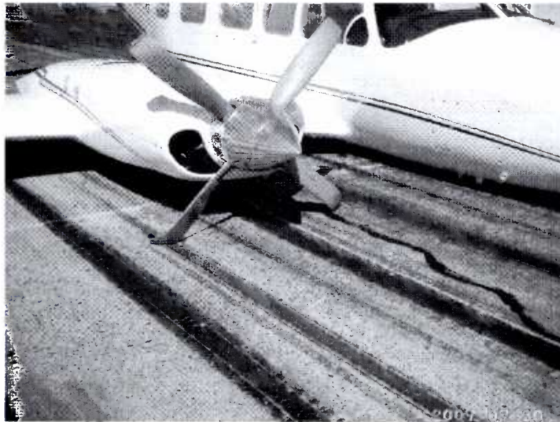
Detalle de los daños en la hélice (Parada súbita del motor)
