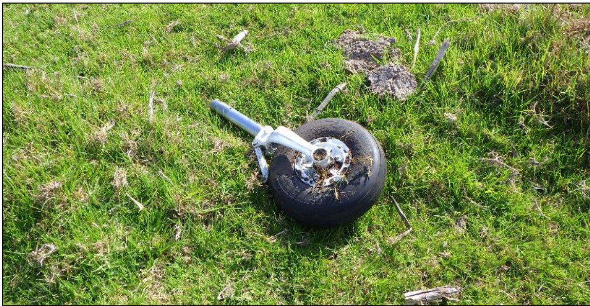
Imagen 6: Desprendimiento del tren de nariz
