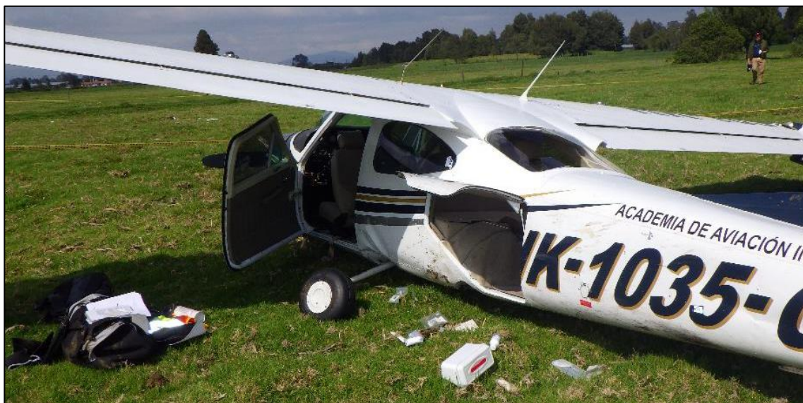
Imagen 7: Deformación del fuselaje, puerta de cabina y plexiglás trasero.
