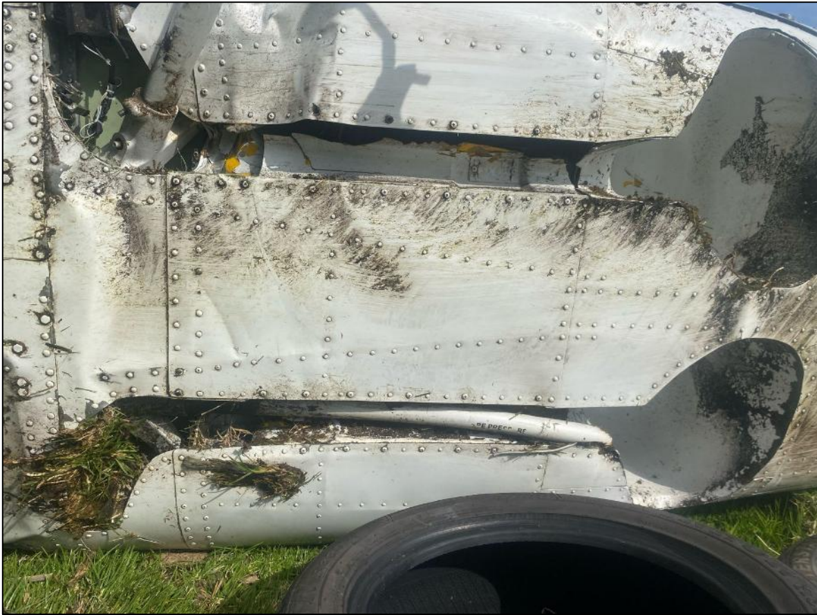
Imagen 8: Deformación y abrasión parte inferior del fuselaje y anidamiento del tren de aterrizaje.
