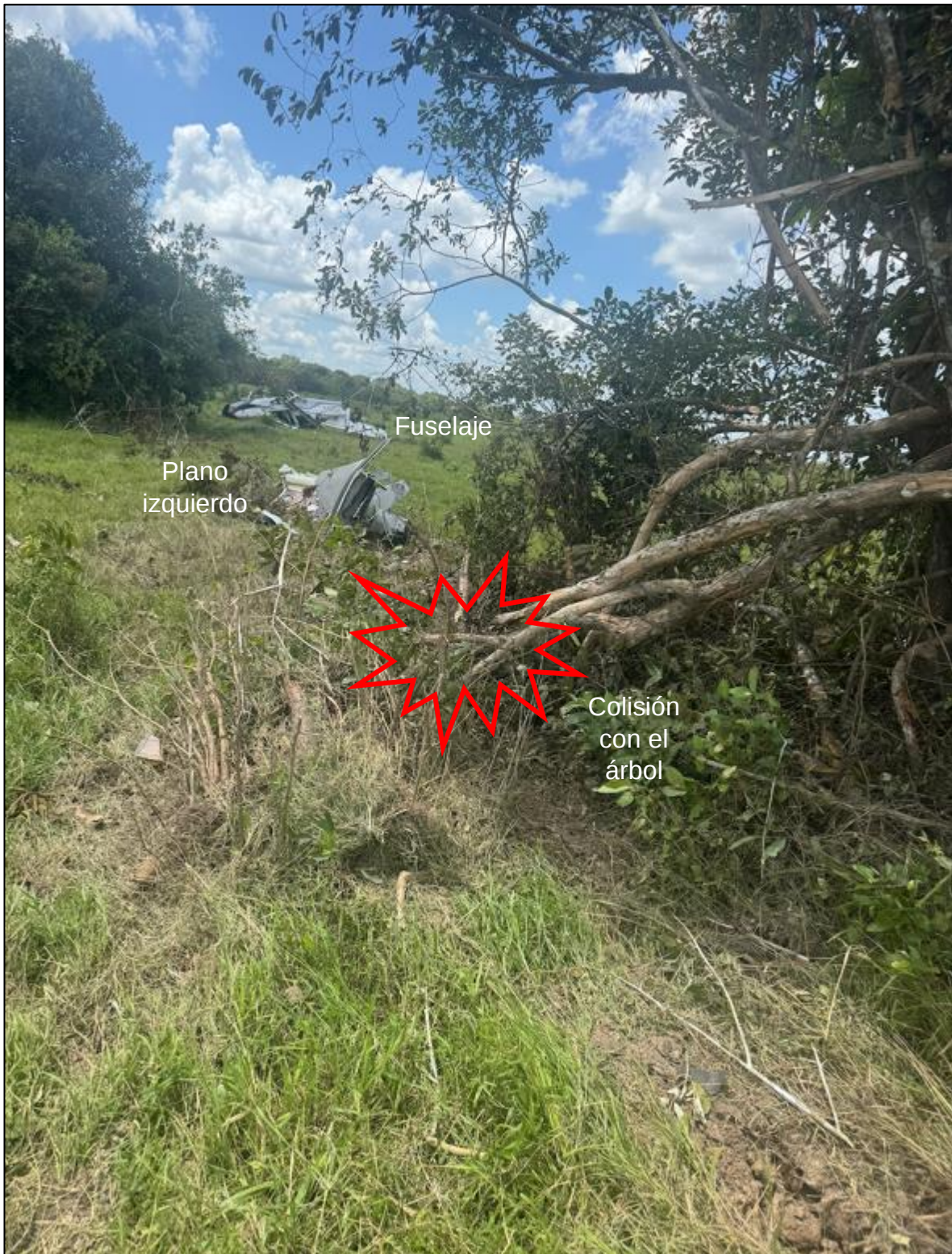
Fotografía No. 2: Punto de impacto y ubicación de componentes principales, HK5259G.
