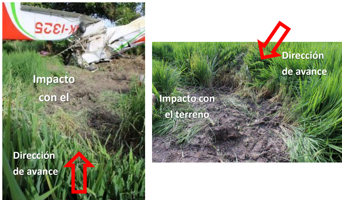
Figura No. 9: imagen del impacto con el terreno de la aeronave HK1325, evidencia corte del pasto por parte de la hélice comprobando que el motor estaba girando y produciendo potencia.
