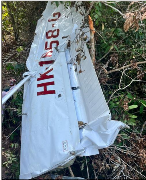
Fotografía No. 4: Izquierda, estado final del plano izquierdo. Derecha, estado final del plano derecho de la aeronave HK 1658-G
