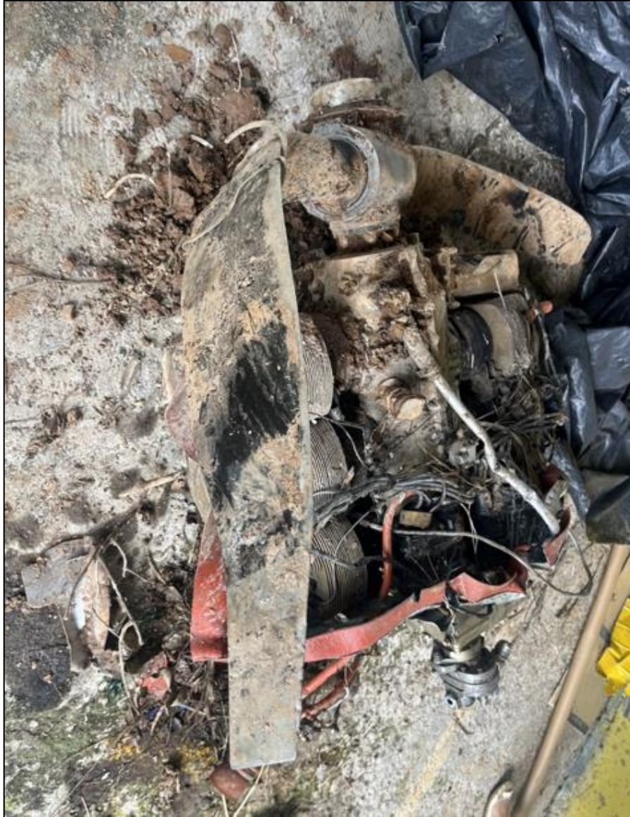
Fotografía No. 3: Planta motriz y hélice con deformación por impacto.
