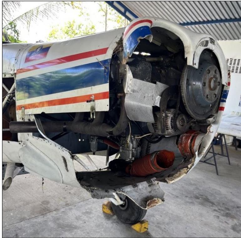
Fotografía No. 3 – Daños presentados la sección frontal de la aeronave.
