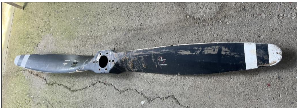
Fotografía No. 4: Hélice con evidencia de no tener potencia en el momento del impacto.
