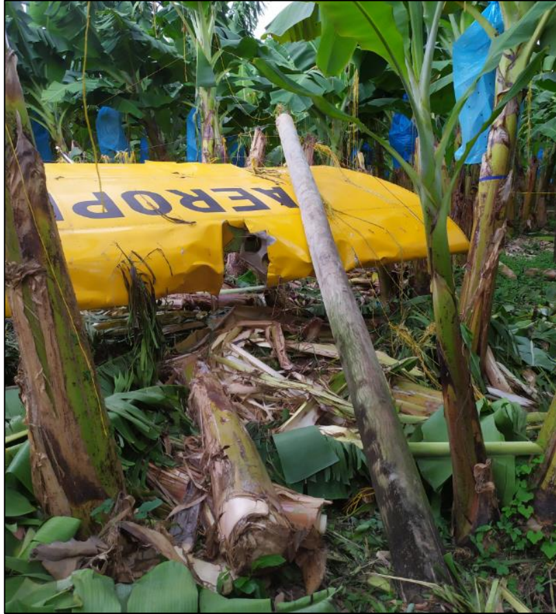
Fotografía No. 5 – Daños en borde de ataque plano izquierdo.
