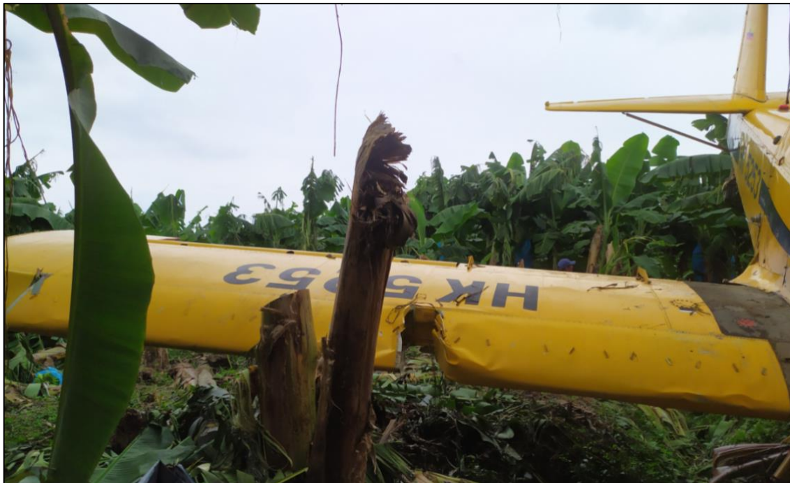
Fotografía No. 6: Daños en borde de ataque plano derecho.
