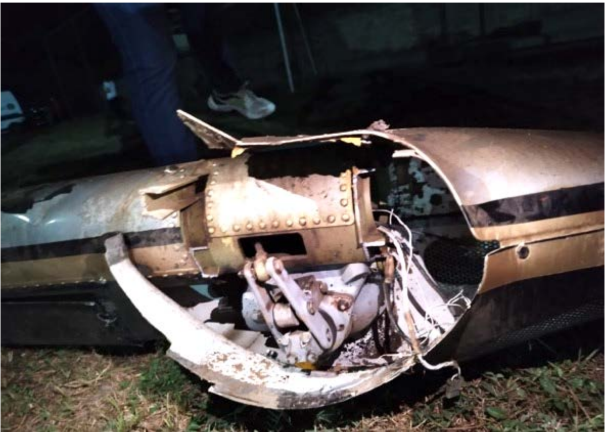
Fotografía No. 6: Engranaje y parte del rotor de cola de la aeronave HK5346.
