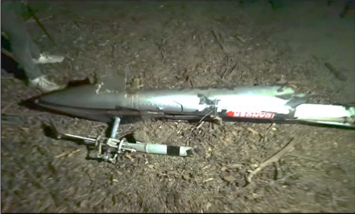
Fotografía No. 5: Condición del rotor de cola de la aeronave HK5346.
