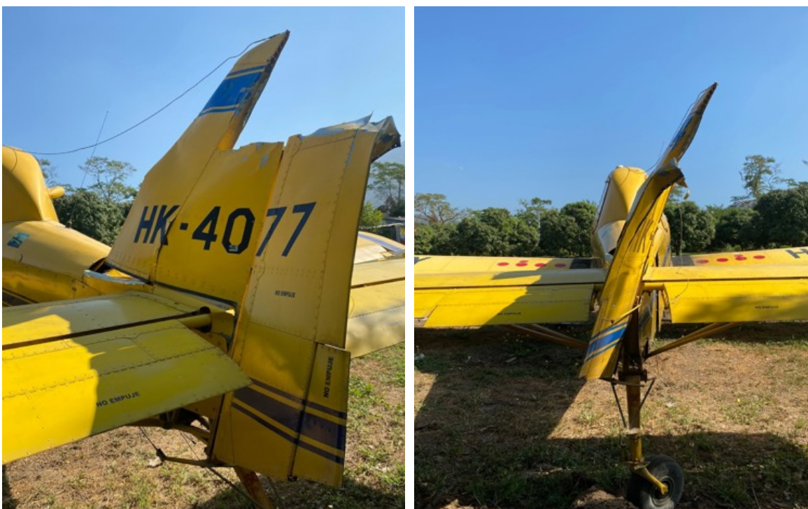
Fotografías No. 5 y 6: Pérdida de una parte y deformación del estabilizador vertical HK4077.
