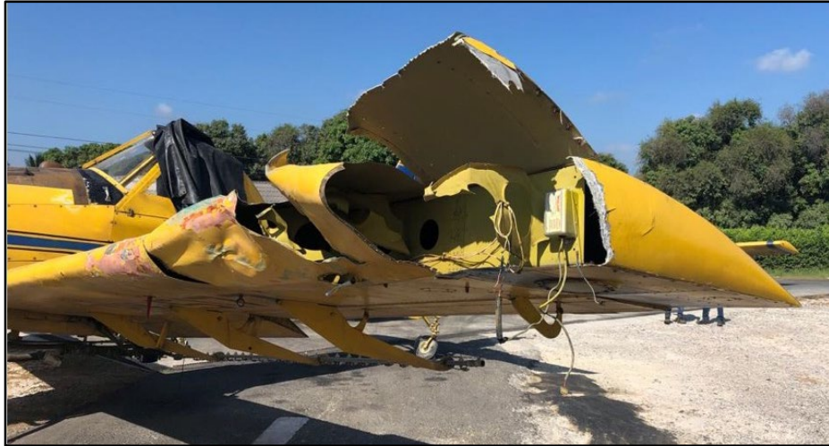
Fotografía No. 7: Daño sustancial en la punta del plano y borde de ataque del plano izquierdo.
