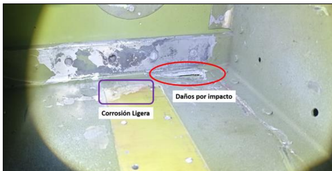
Fotografía No. 8 – Afectación en la zona interior del plano
