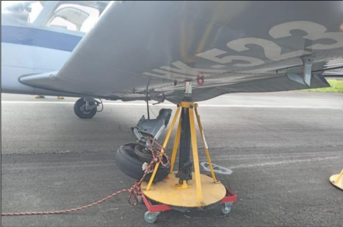
Fotografía No. 4 – Condición del del tren de aterrizaje principal izquierdo como consecuencia del colapso en el aterrizaje en Vanguardia.
