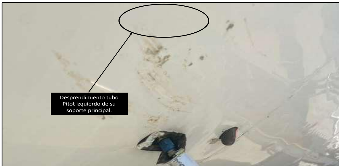
Fotografía No. 7: Desprendimiento tubo pitot.
