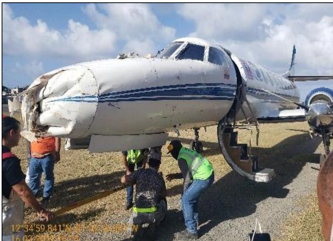
Fotografía No. 4: Daños sufridos en la sección de nariz por la aeronave HK5225.
