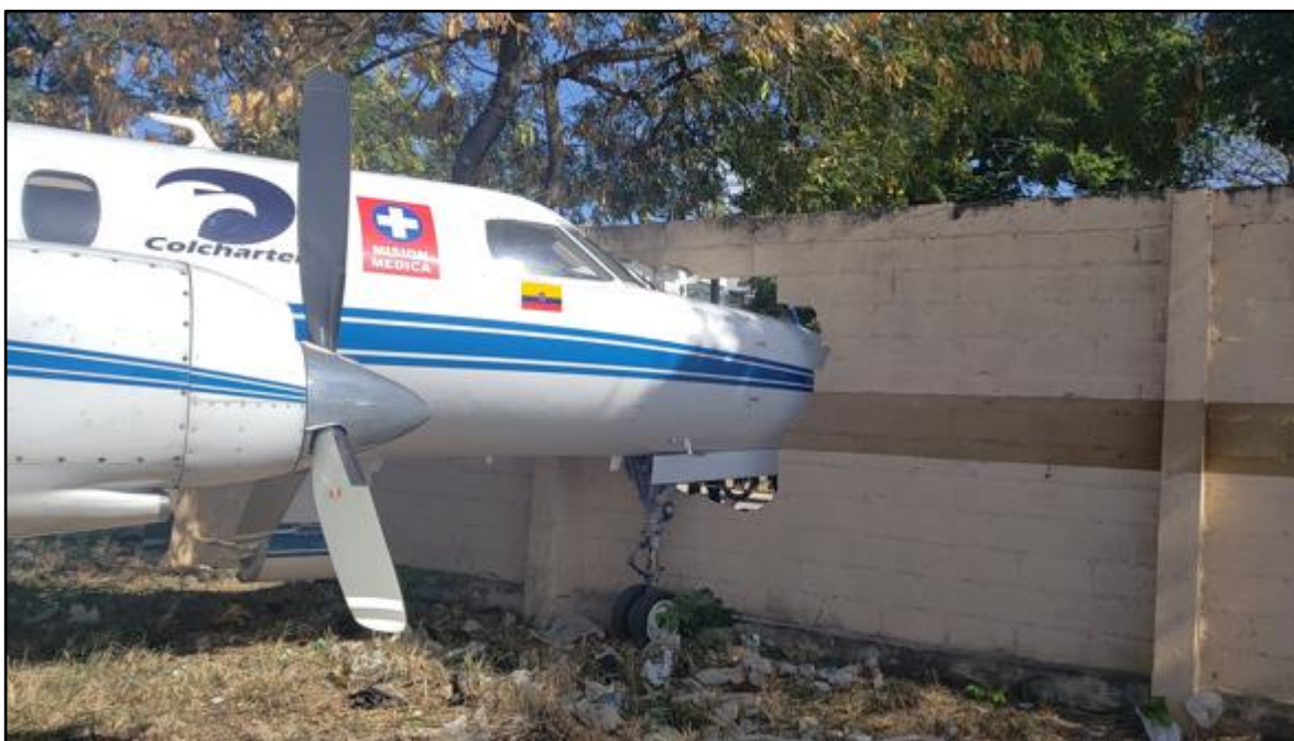
Fotografía No. 3: Detalle del impacto con el muro perimetral.
