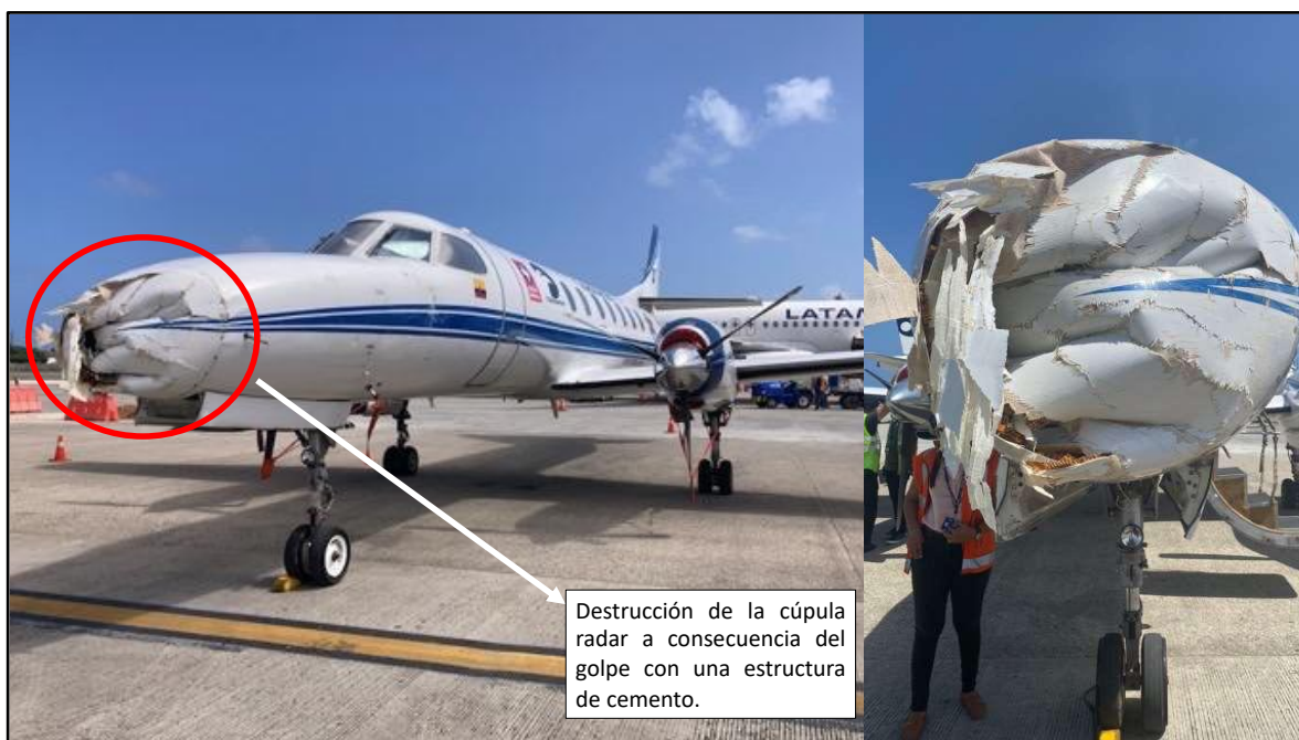
Fotografía No. 5: Daños de la cúpula radar del HK5225.
