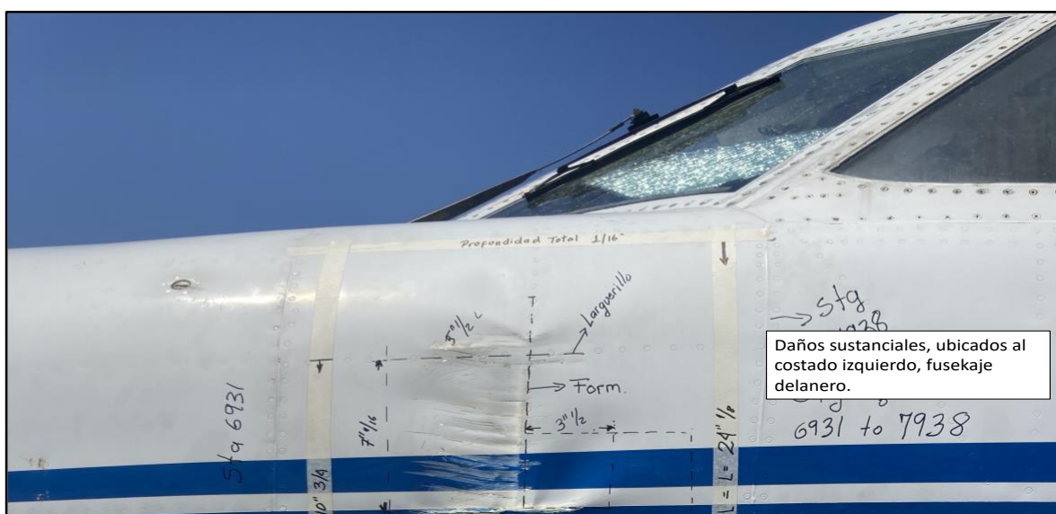
Fotografía No. 6: Daños fuselaje izquierdo del HK5225.
