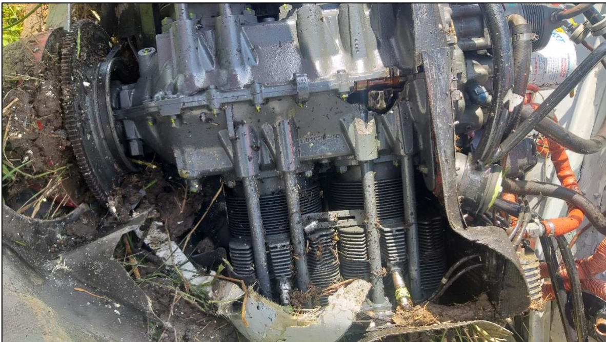
Fotografía No. 3 - Condición del motor en escena. Se observa daño en el cárter.
