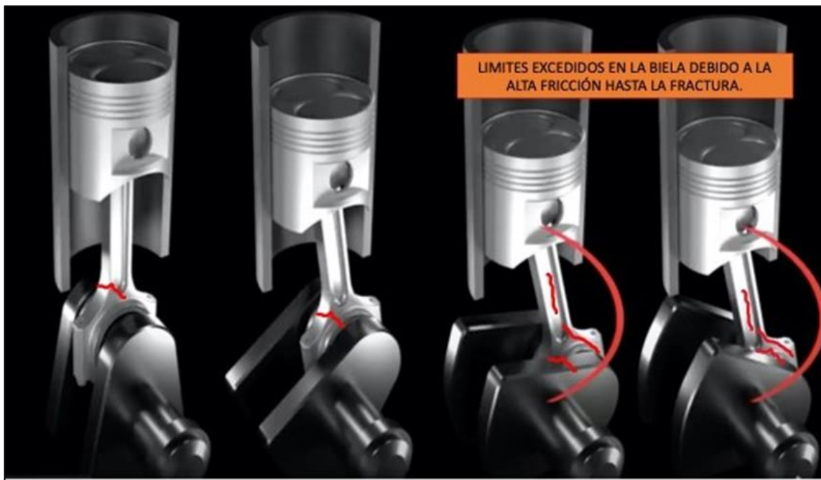
Imagen No. 3: Ubicación de los límites excedidos en la biela.
