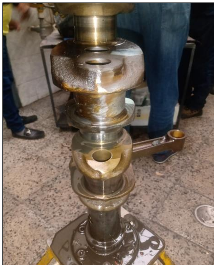
Fotografías No. 7 y 8: Material fundido en el cigüeñal por alta temperatura y falta de lubricación por obstrucción
