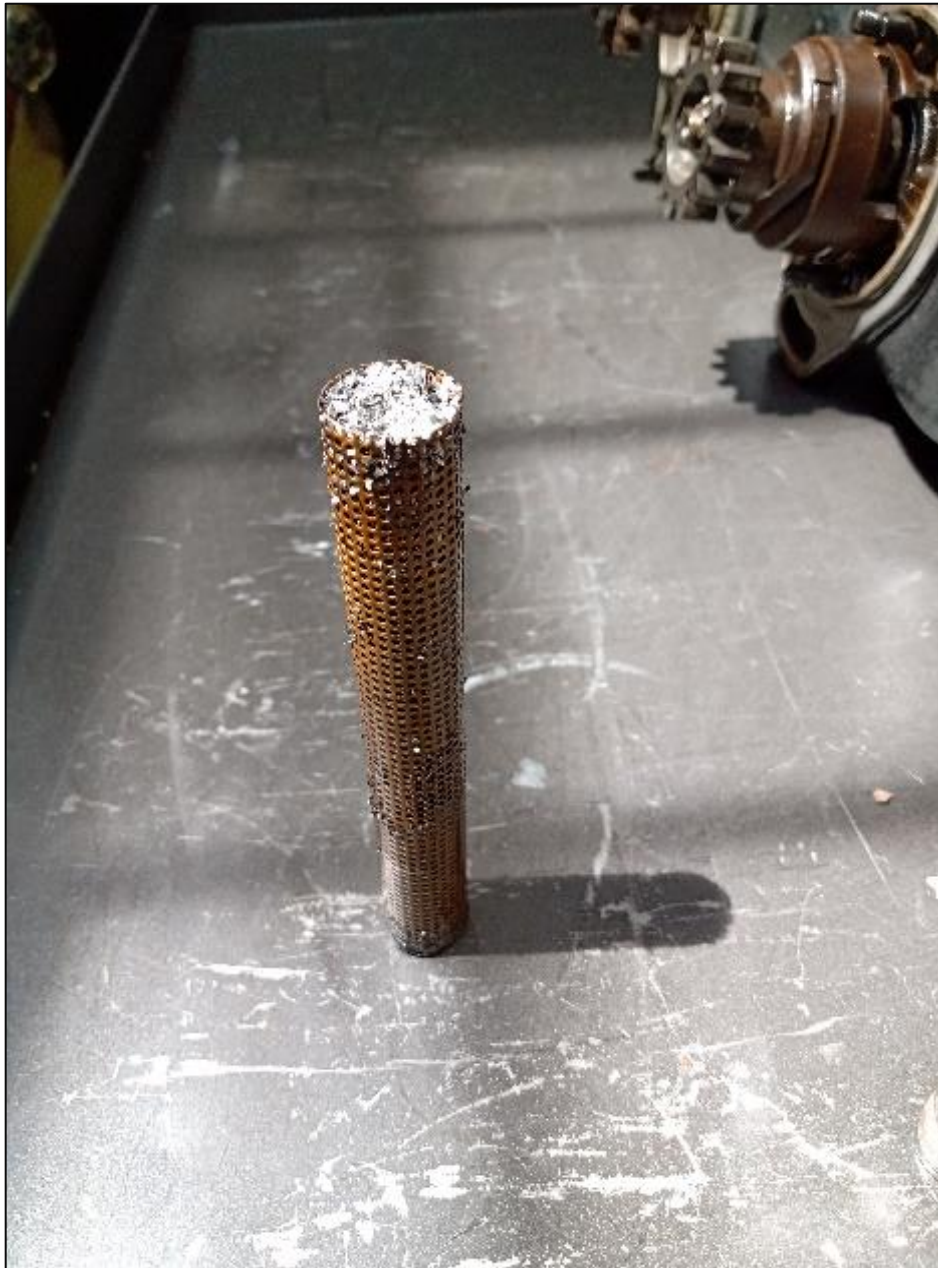
Fotografía No. 6: evidencias de limalla en el filtro de aceite.
