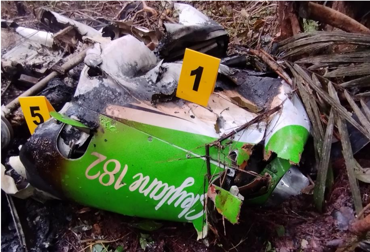
Fotografía No. 13: Condición final de la planta motriz
