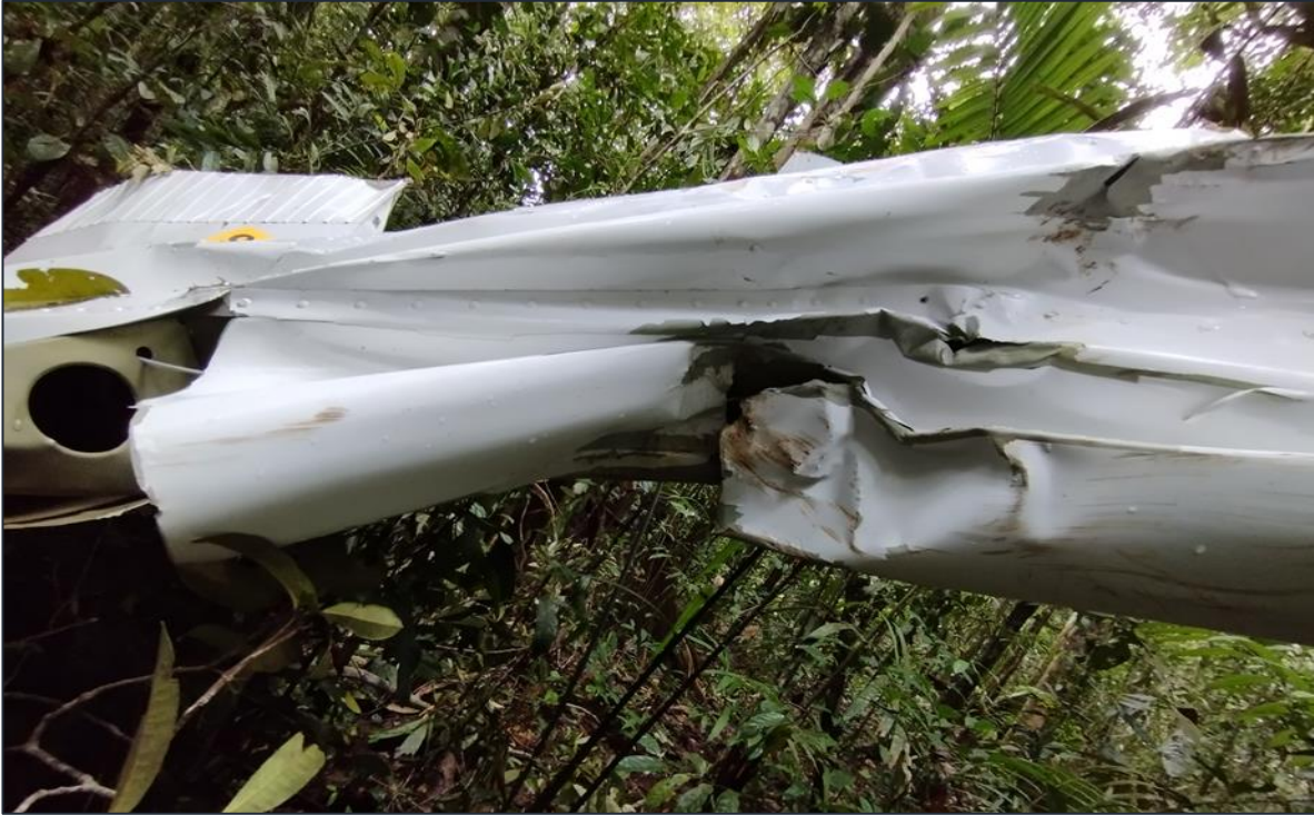
Fotografía No. 8: Impacto en el plano derecho de la aeronave HK1464.
