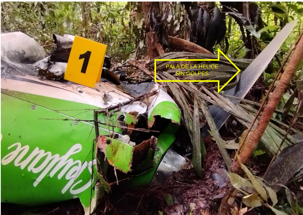
Fotografía No. 12: Pala de la hélice sin golpes ni torceduras.
