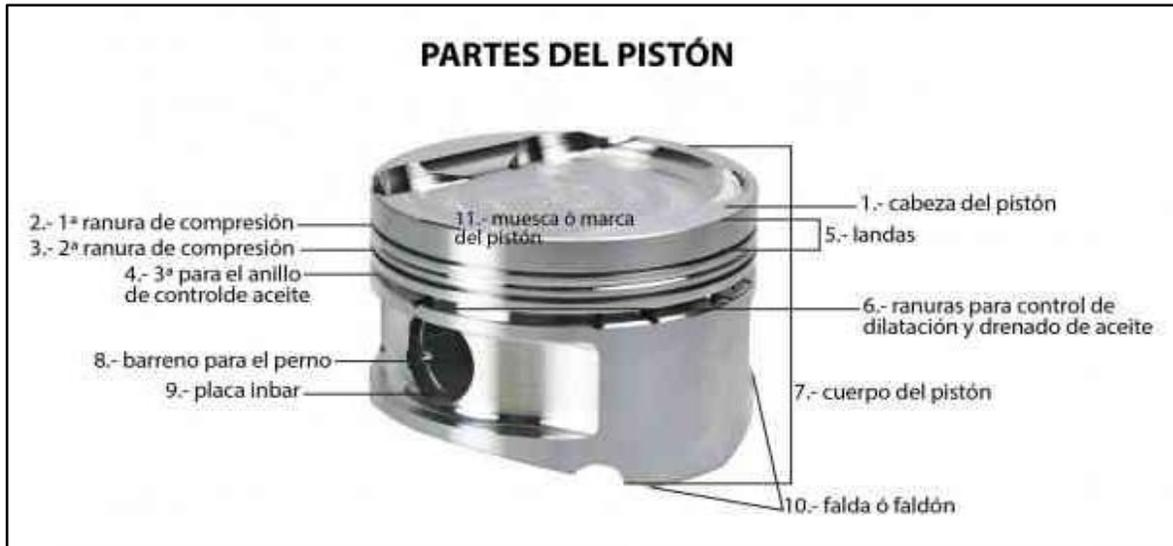
*Figura No. 10: Partes de un pistón.*
