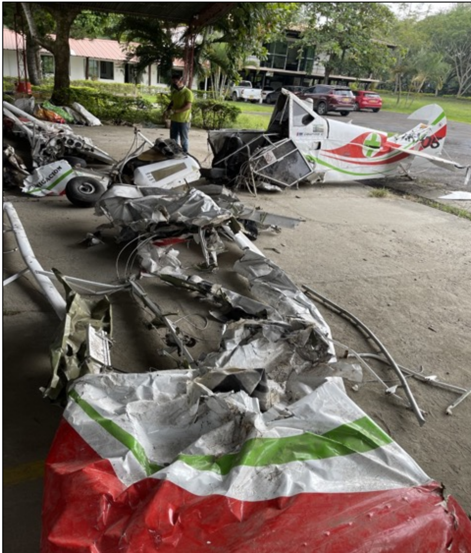
Fotografía No. 3 - Reconstrucción de los restos de la aeronave.
