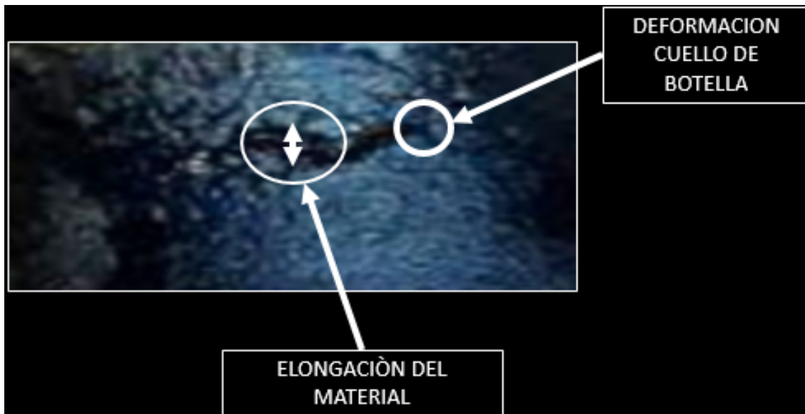
Fotografía No. 7 - Detalles de la fractura.
