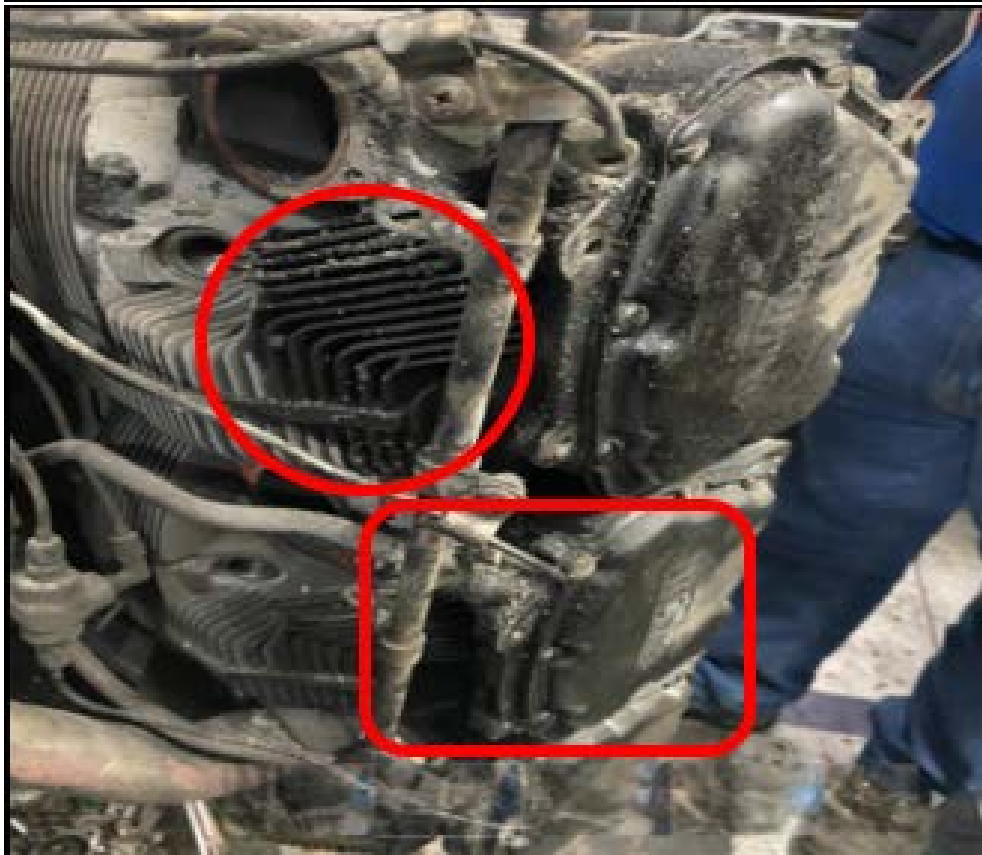
Fotografía No. 5 - Marcas de aceite de motor en los cilindros 4 y 6.
