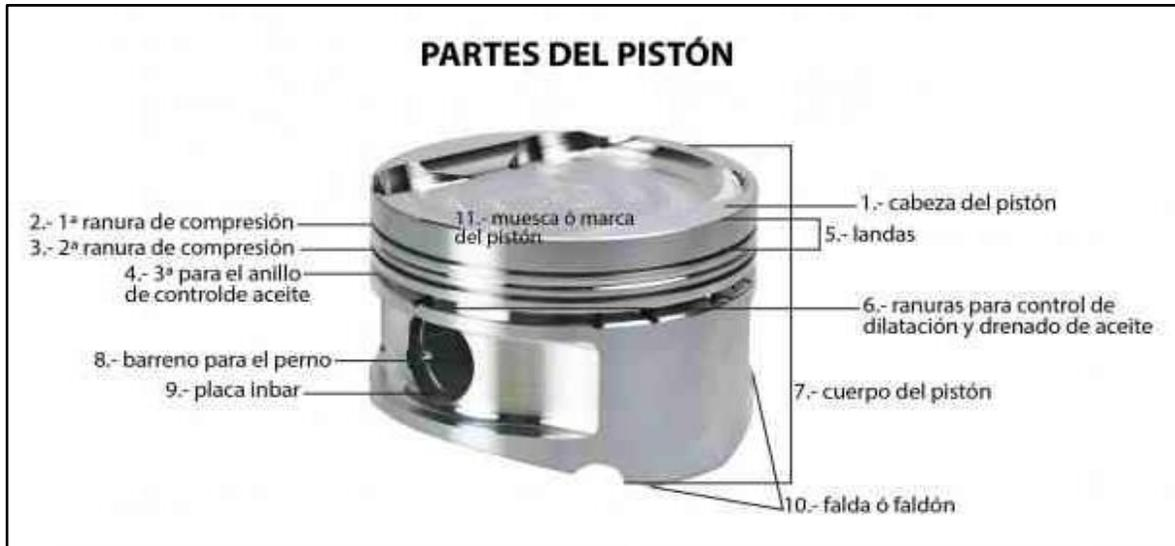
**Fotografía No. 22: Partes de un pistón.**
