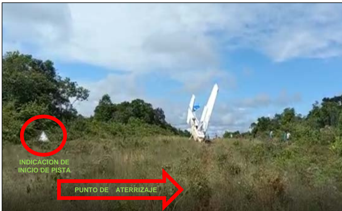
Fotografía No. 3 - Punto de contacto con el terreno antes del umbral de la pista.
