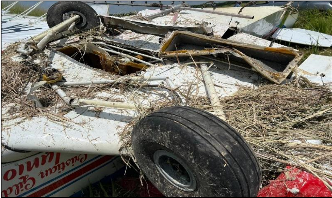
Fotografía No. 4 – Daño en los trenes principales de aterrizaje.
