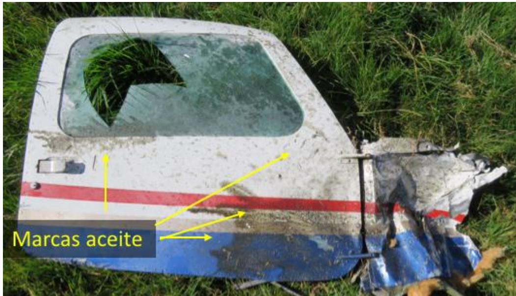
Fotografía No. 3 – Marcas de aceite en la sección exterior de puerta derecha frontal HK2335G
