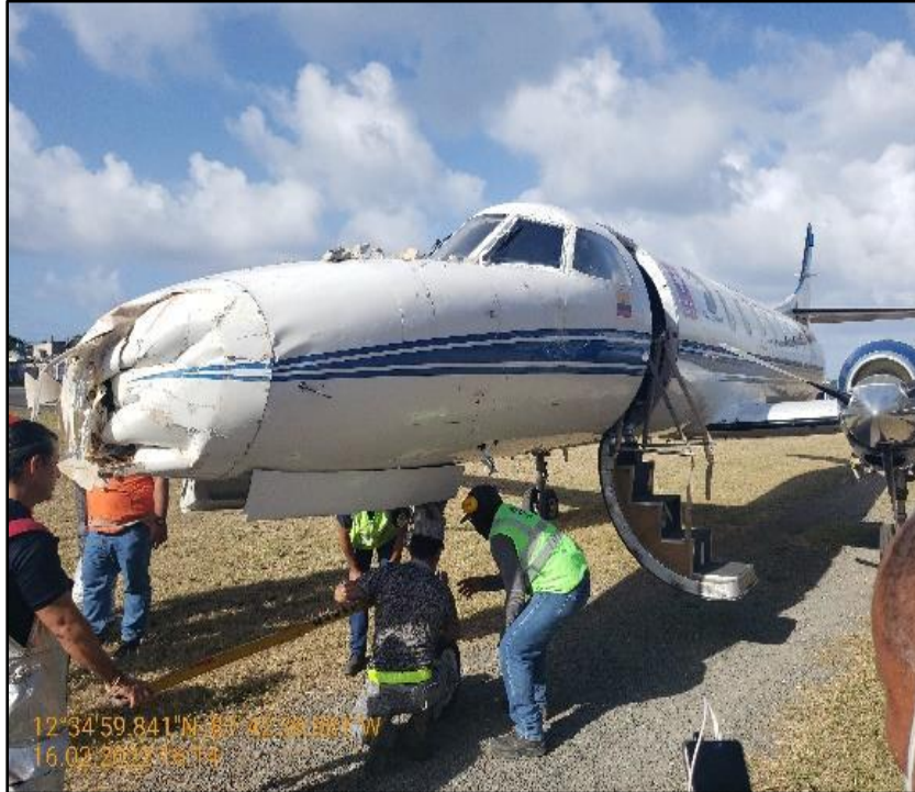
Fotografía No. 4 Daños sufridos por la aeronave HK5225.
