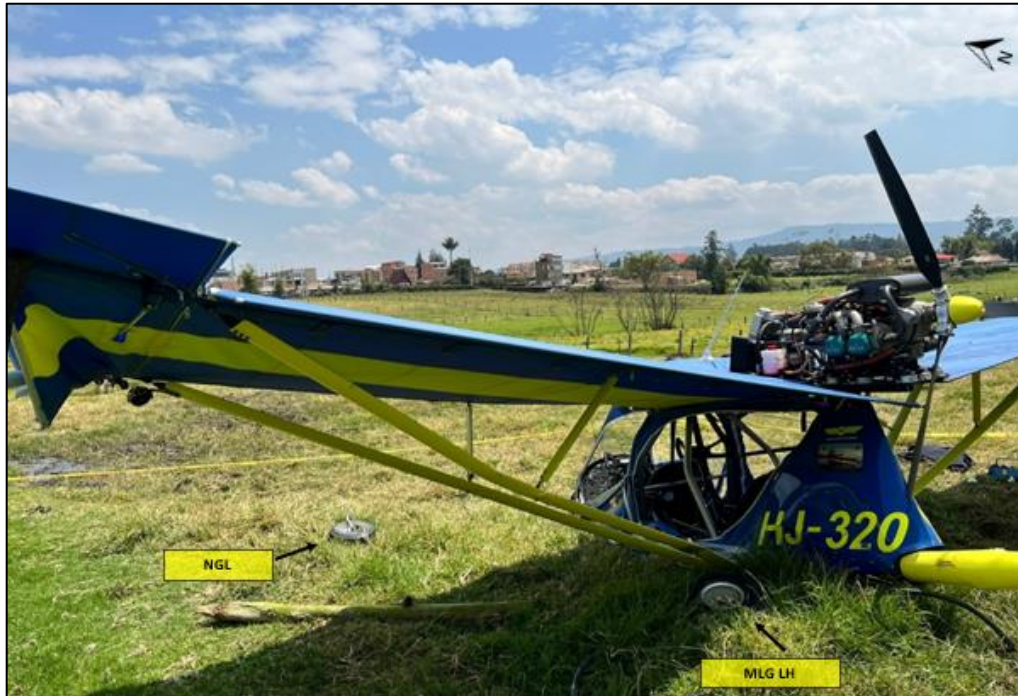
Fotografía No. 5 – Estado general del tren de aterrizaje.
