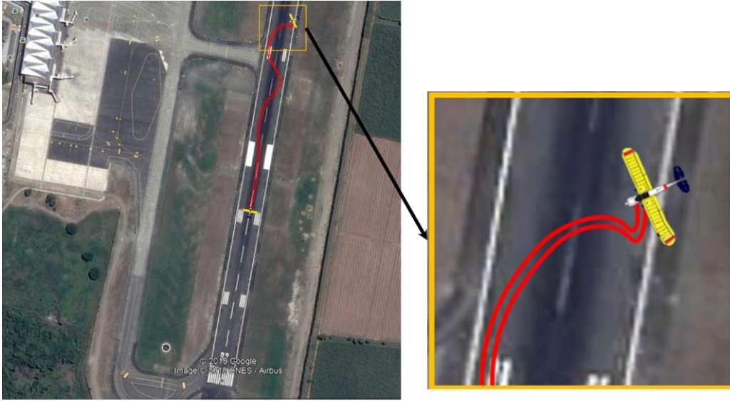
Imagen No. 1 Secuencia de eventos, trayectoria descrita por la aeronave posterior al aterrizaje, durante su desaceleración en la pista
