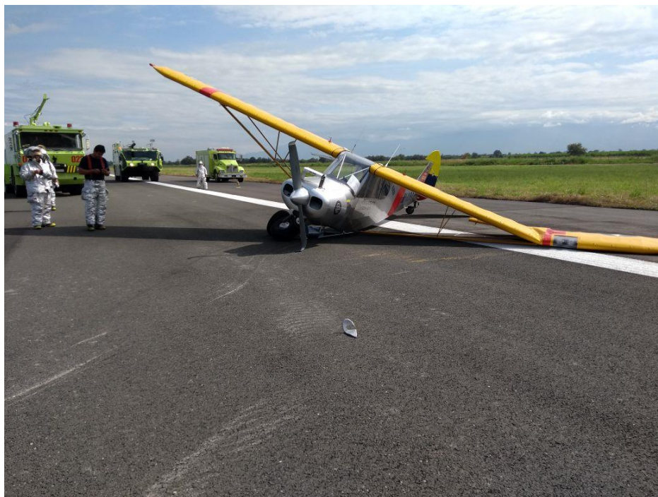
Fotografía No.2 Condición final de la aeronave HK630G, Daños en el tren principal, plano izquierdo, hélice, motor, entre otros
